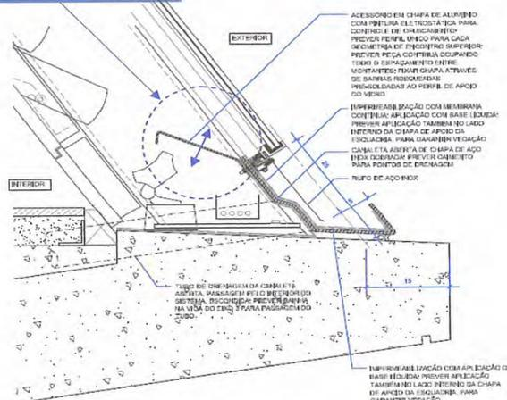
5 DETALHE INTERIOR - EGS 1.2 NA BORDA DE LAJE (1o. PAVIMENTO)
