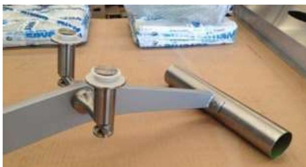
Foi apresentada uma amostra conforme solicitado, contendo um trecho da estrutura de aço, spiders e corrimão de aço inox integrado.
