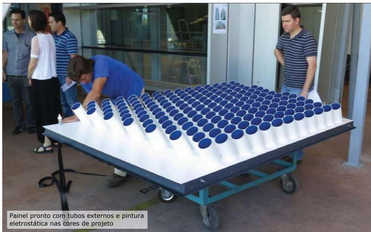
Painel pronto com tubos externos e pintura eletrostática nas cores de projeto
