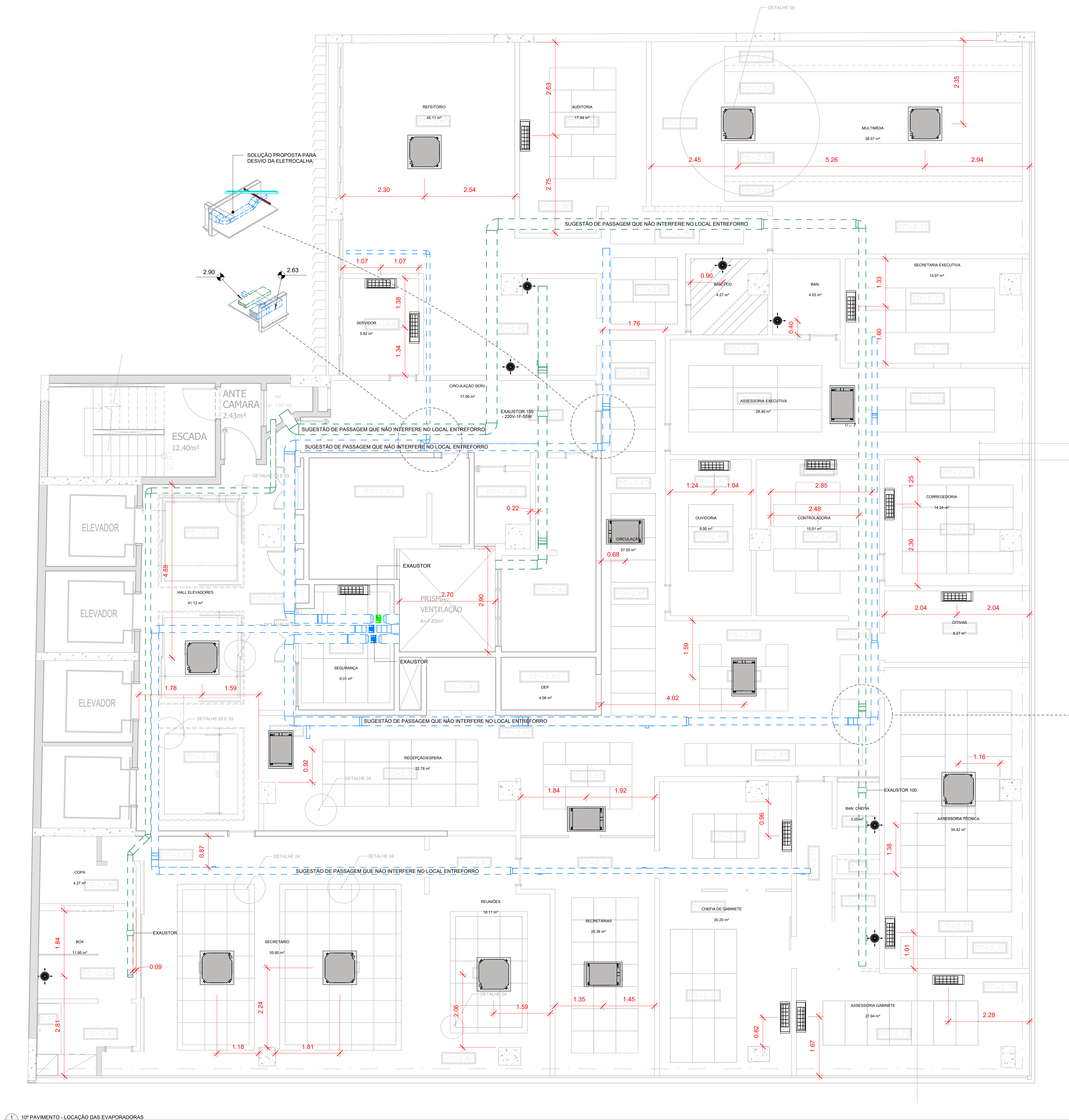
1. 10º PAVIMENTO - LOCAÇÃO DAS EVAPORADORAS Escala: 1:50
