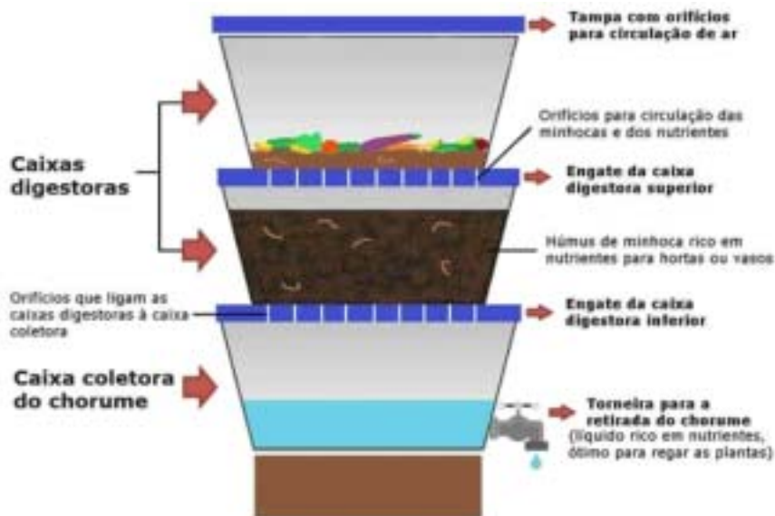
FIGURA 22 - Imagem ilustrativa do funcionamento interno de uma vermicomposteira.
