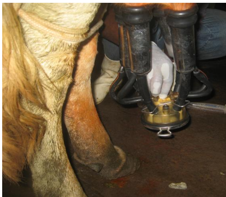
Figura 14: Desligamento do vácuo para a correta retirada das teteiras.
