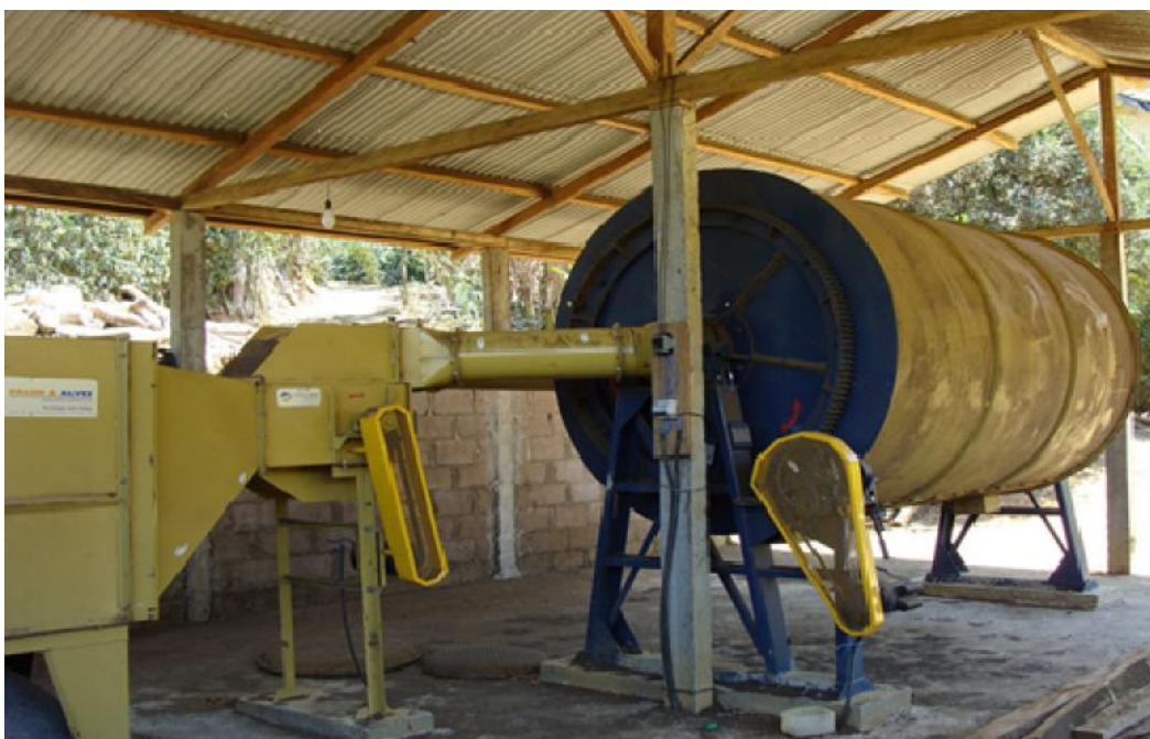
Secador de café instalado na Microbacia Bom Sucesso, na propriedade de José Maria Pelegrini, Distrito de Purilândia (Porciúncula-RJ). É um secador metálico cilíndrico rotativo, modelo PA-SR/7.6, com capacidade para 7.600 litros de café/dia. Foto de 2013.
