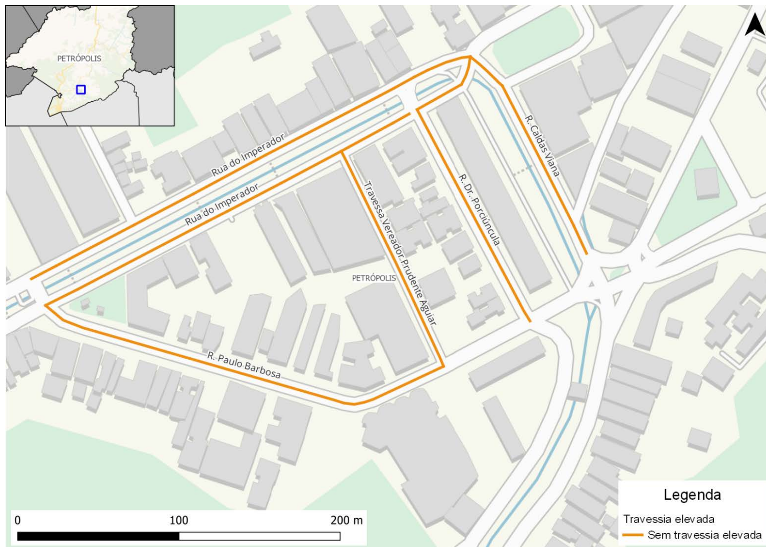
Figura 209: Travessia elevada de pedestre na rede inventariada de Petrópolis
