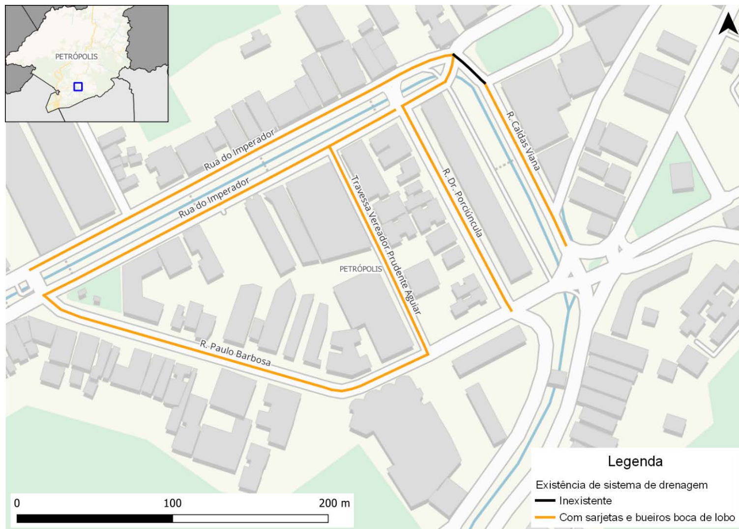
Figura 207: Equipamentos de drenagem na rede inventariada de Petrópolis
