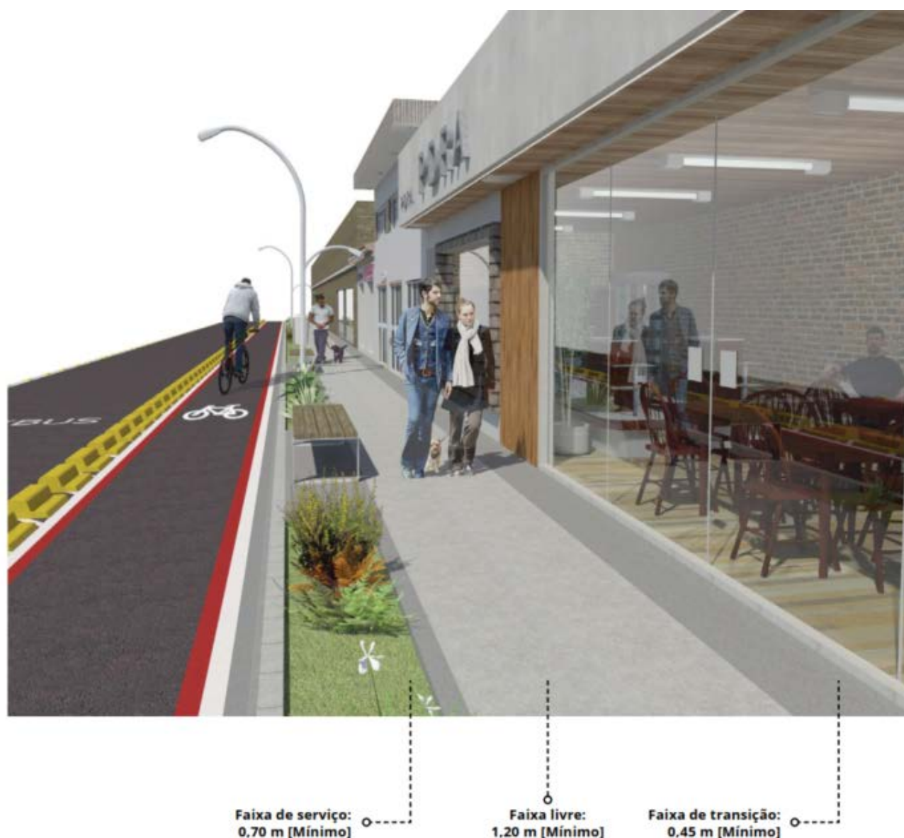
Figura 143: Recomendações de dimensionamento da largura das calçadas
