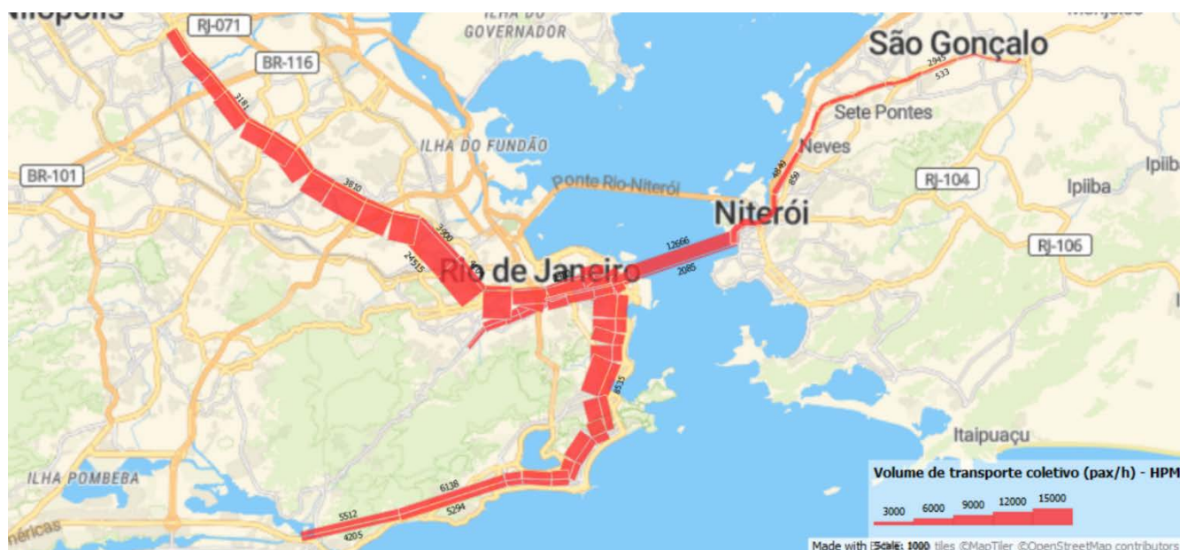
Figura 76: Carregamento dos sistemas de metrô na RMRJ, com implantação da Linha 3, no horizonte 2034
