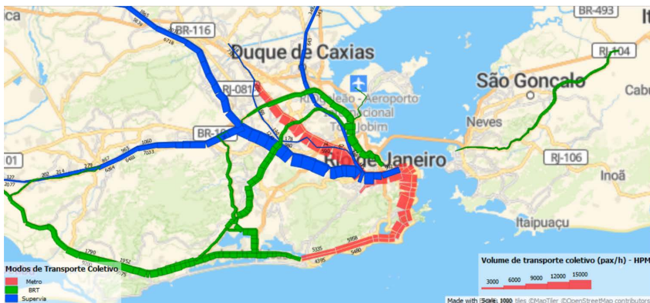
Figura 81: Carregamento dos sistemas de média e alta capacidade da RMRJ, com a intervenção do BRT Niterói Manilha, no horizonte 2034
