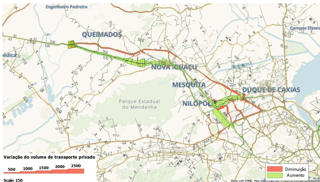
Figura 84: Comparação de volumes do transporte privado, entre os cenários prognóstico e com intervenções na via Light
