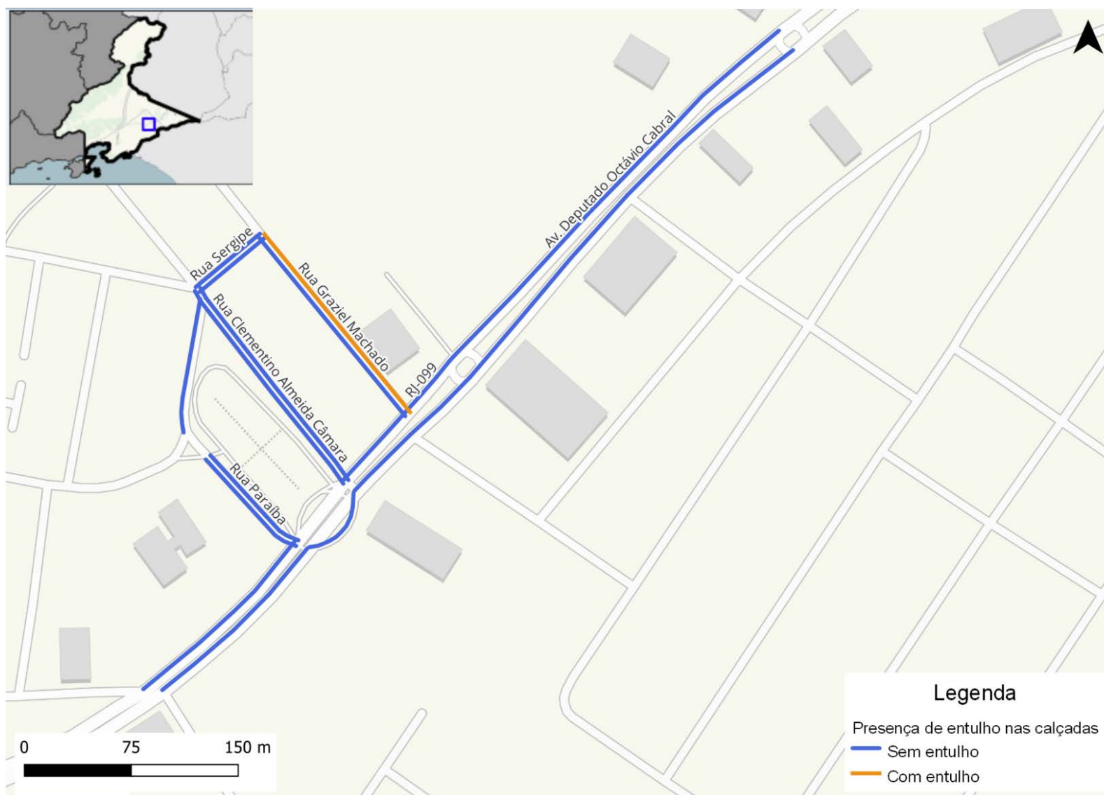
Figura 222: Presença de entulho nas calçadas para a rede inventariada de Itaguaí
