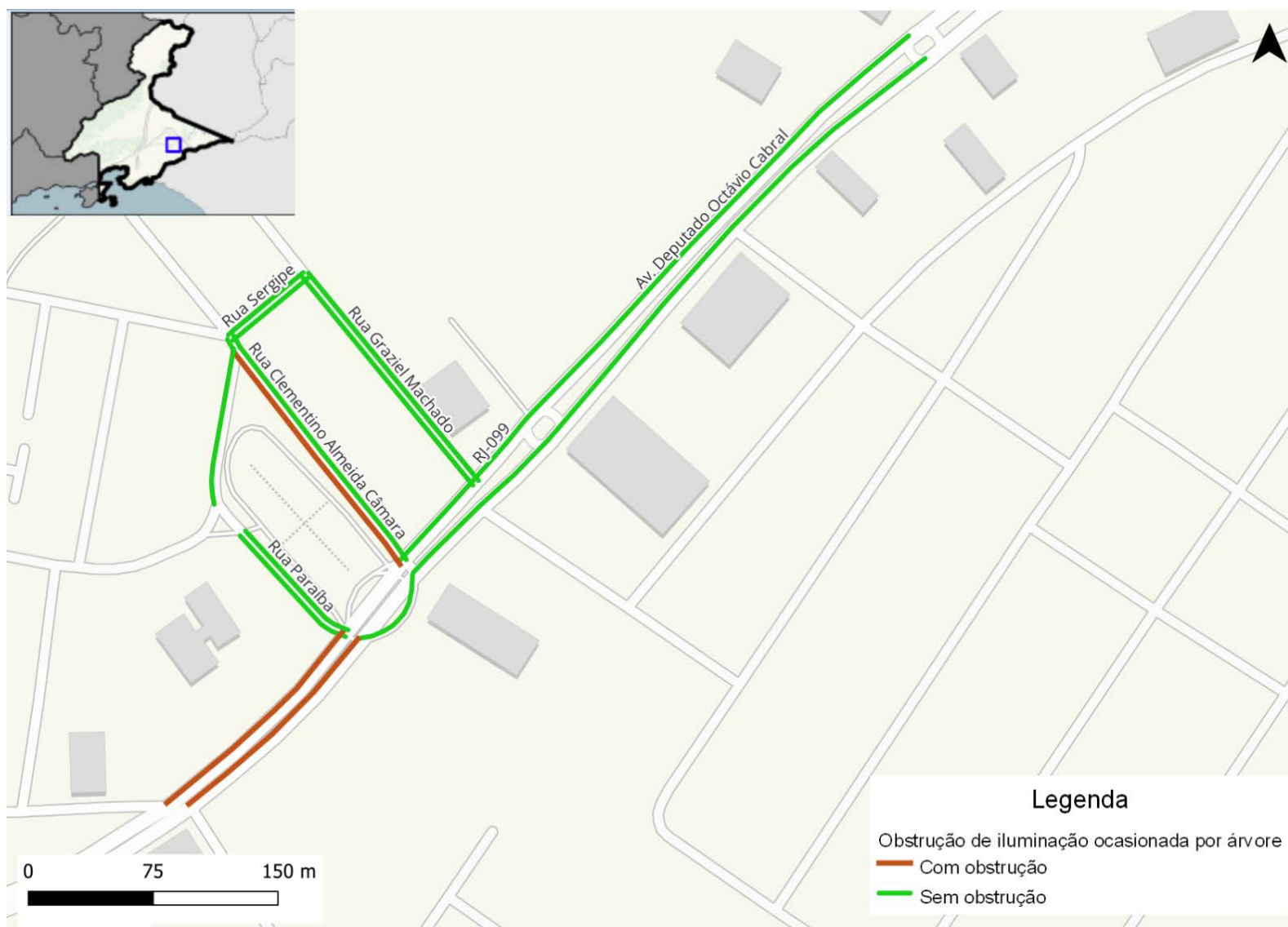
Figura 219: Obstrução de iluminação ocasionada por árvore nas calçadas da rede inventariada de Itaguaí
