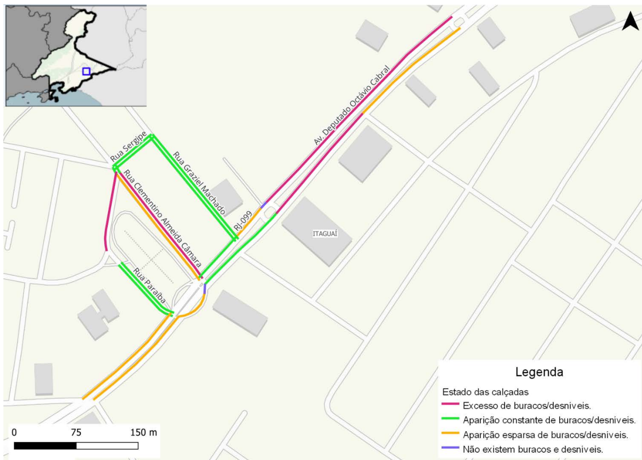
Figura 119: Estado das calçadas no entorno da região inventariada de Itaguaí
