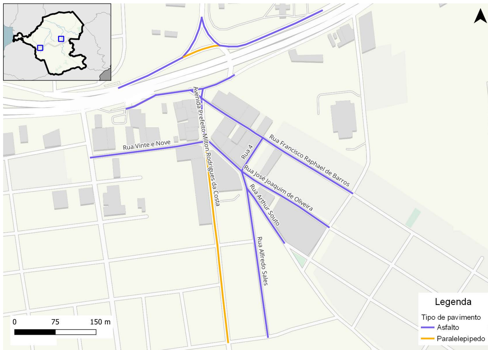
Figura 237: Tipo de pavimento na rede inventariada de Itaboraí (Manilha)
