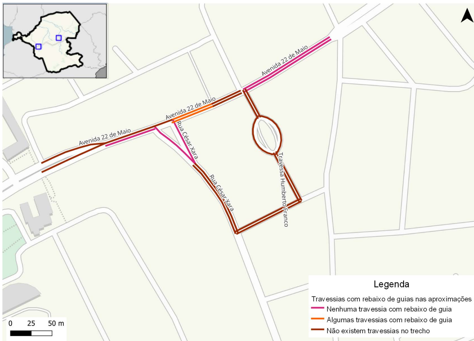
Figura 303: Travessias com rebaixo de guia nas aproximações na rede inventariada de Itaboraí (Venda das Pedras)
