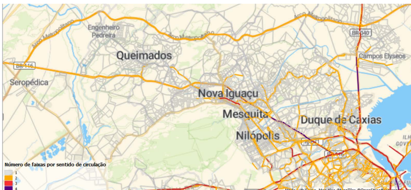
Figura 51: Detalhe com o número de faixas da Via Dutra e Arco metropolitano
