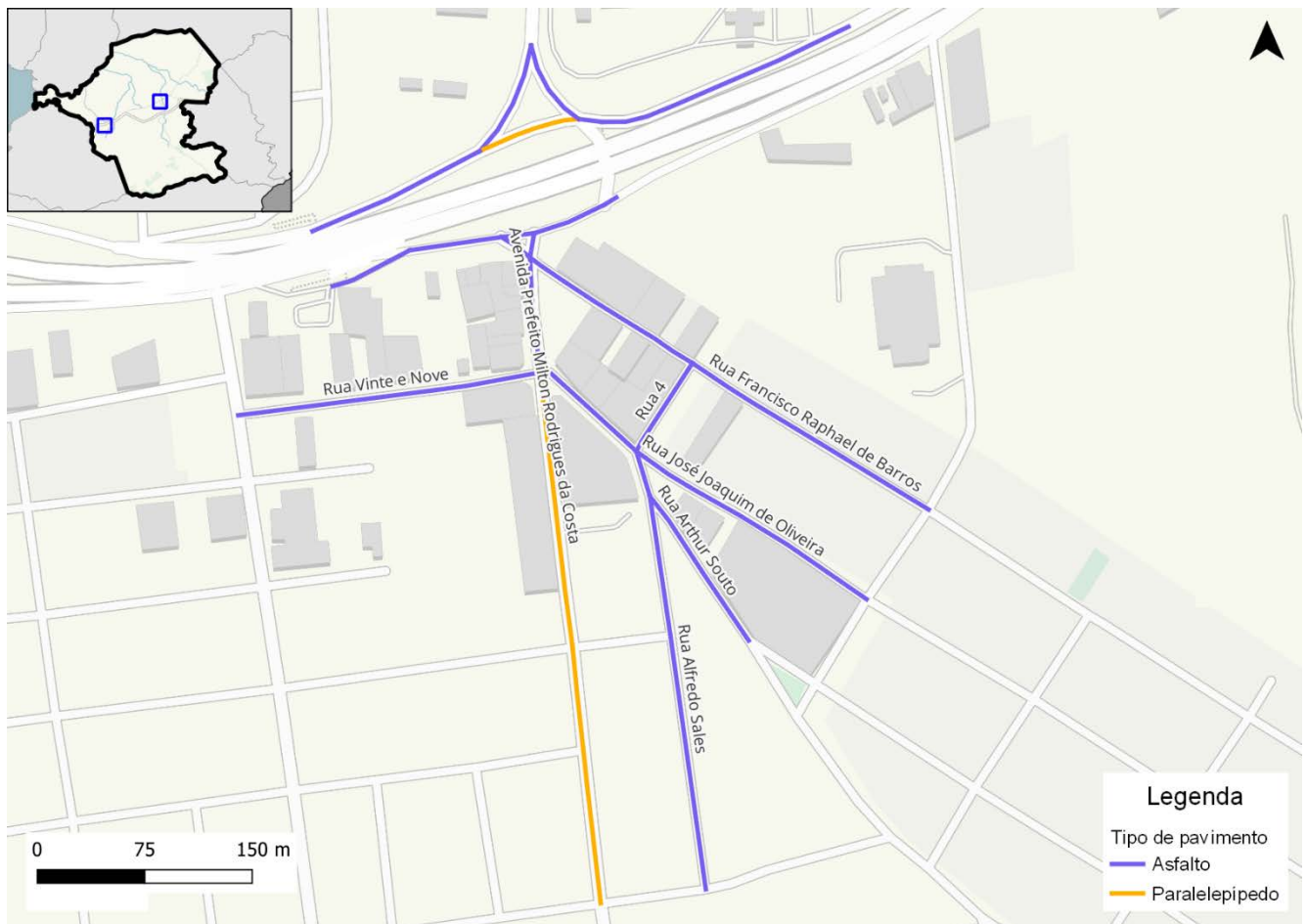
Figura 116: Tipo de pavimento na região do entorno do terminal de Manilha
