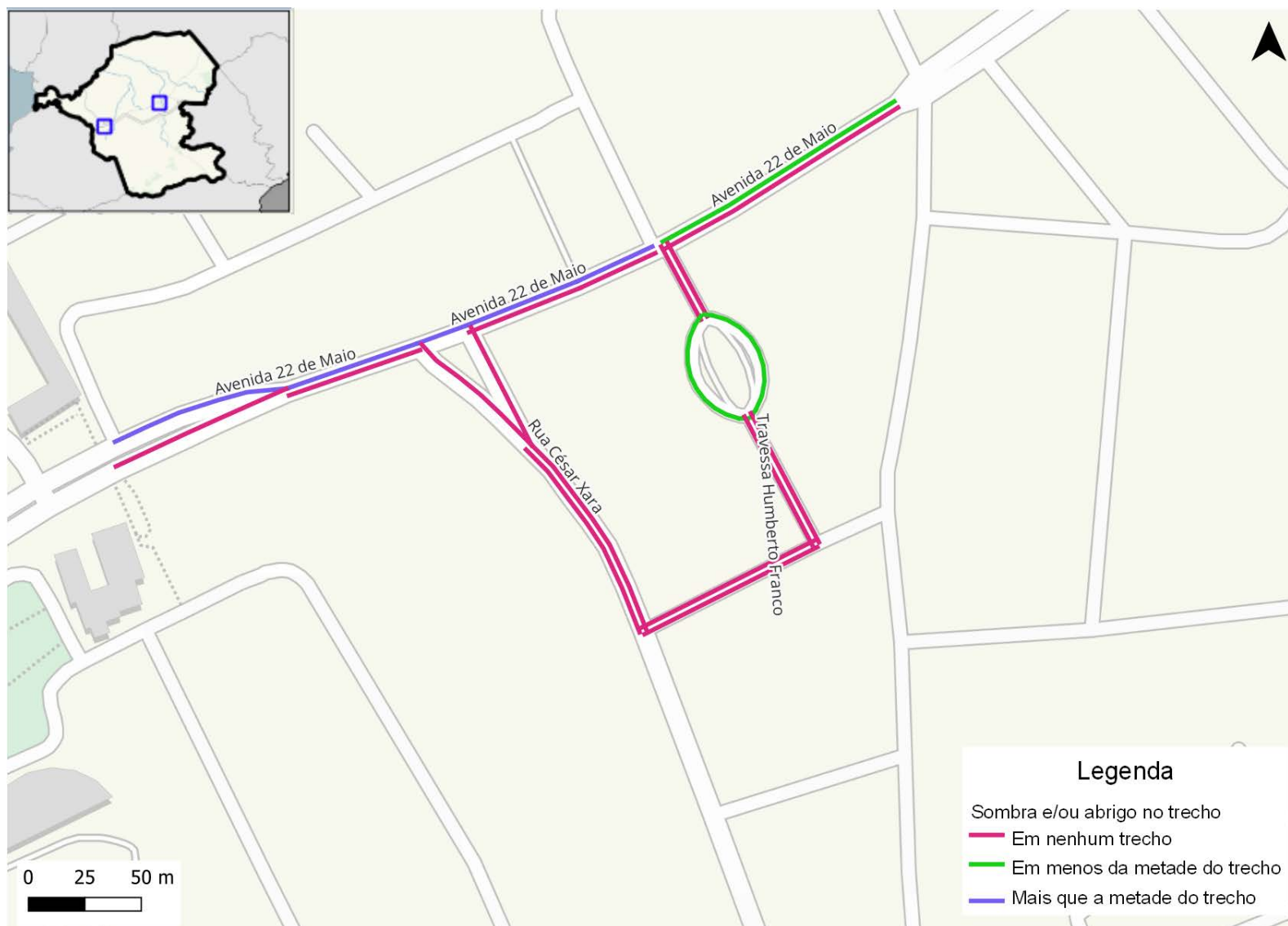
Figura 298: Presença de sombra e abrigo nas calçadas da rede inventariada de Itaboraí (Venda das Pedras)
