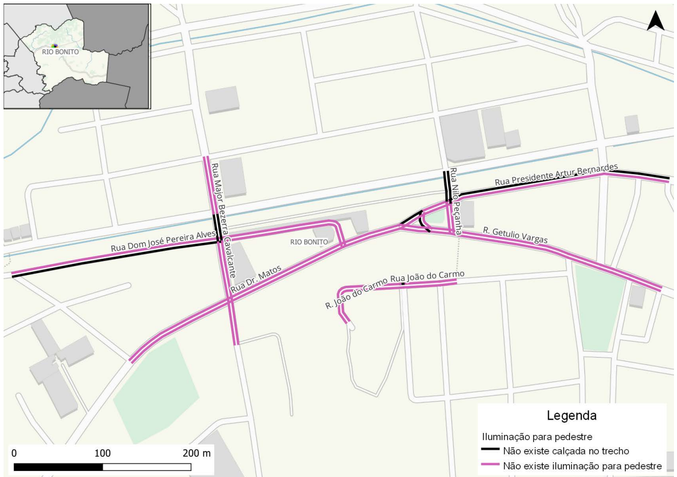
Figura 124: Iluminação para pedestre no entorno da Rodoviária de Rio Bonito
