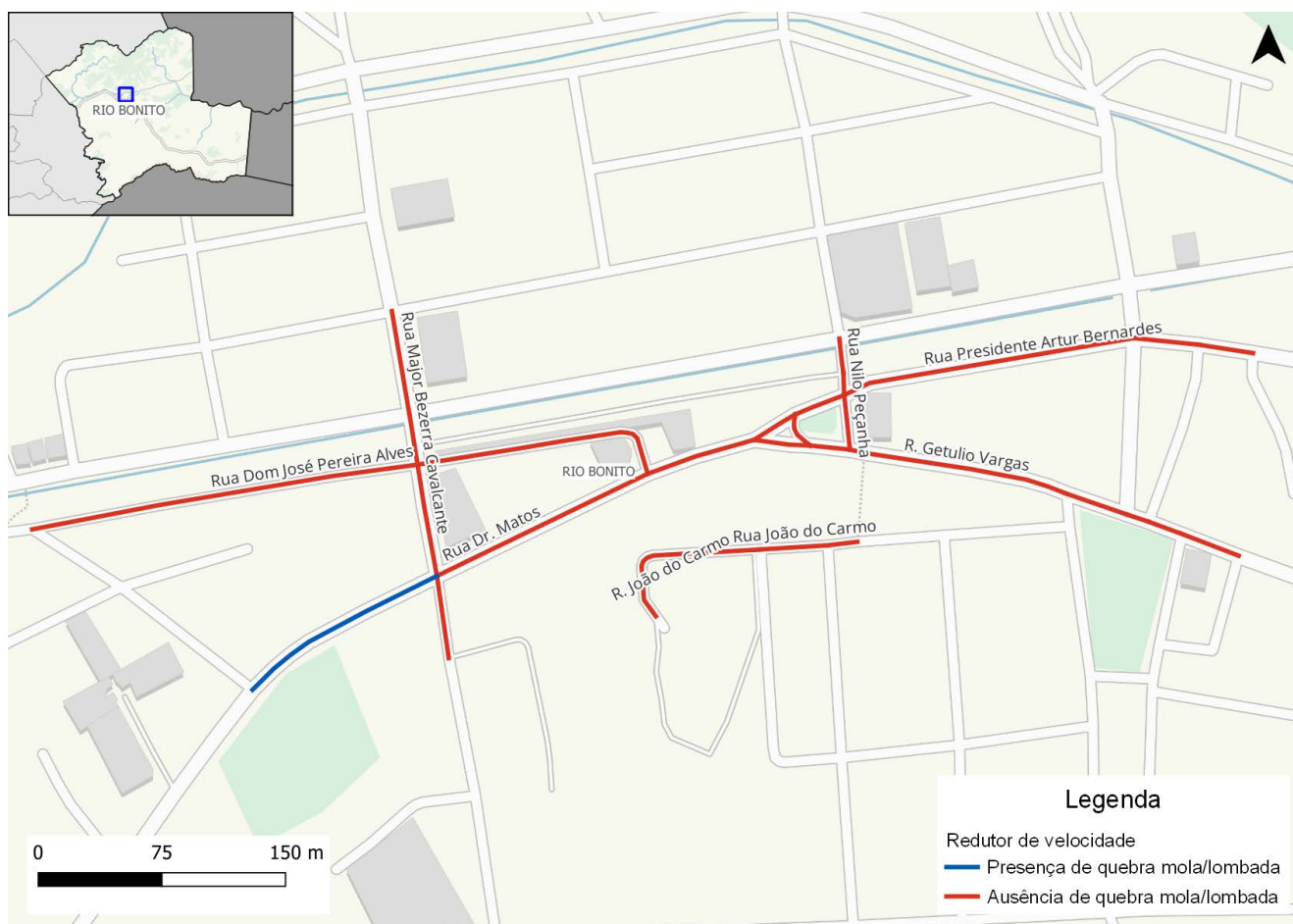
Figura 140: Redutores de velocidade no entorno da Rodoviária de Rio Bonito
