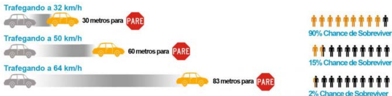
Figura 188: Relação entre velocidade dos automóveis e taxa de mortalidade em atropelamentos
