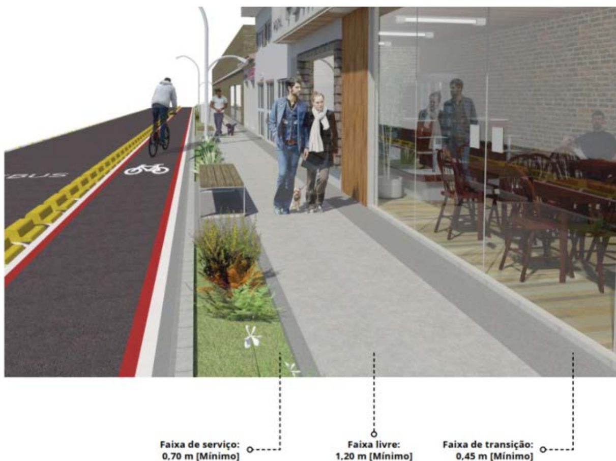
Figura 156: Recomendações de dimensionamento da largura das calçadas
