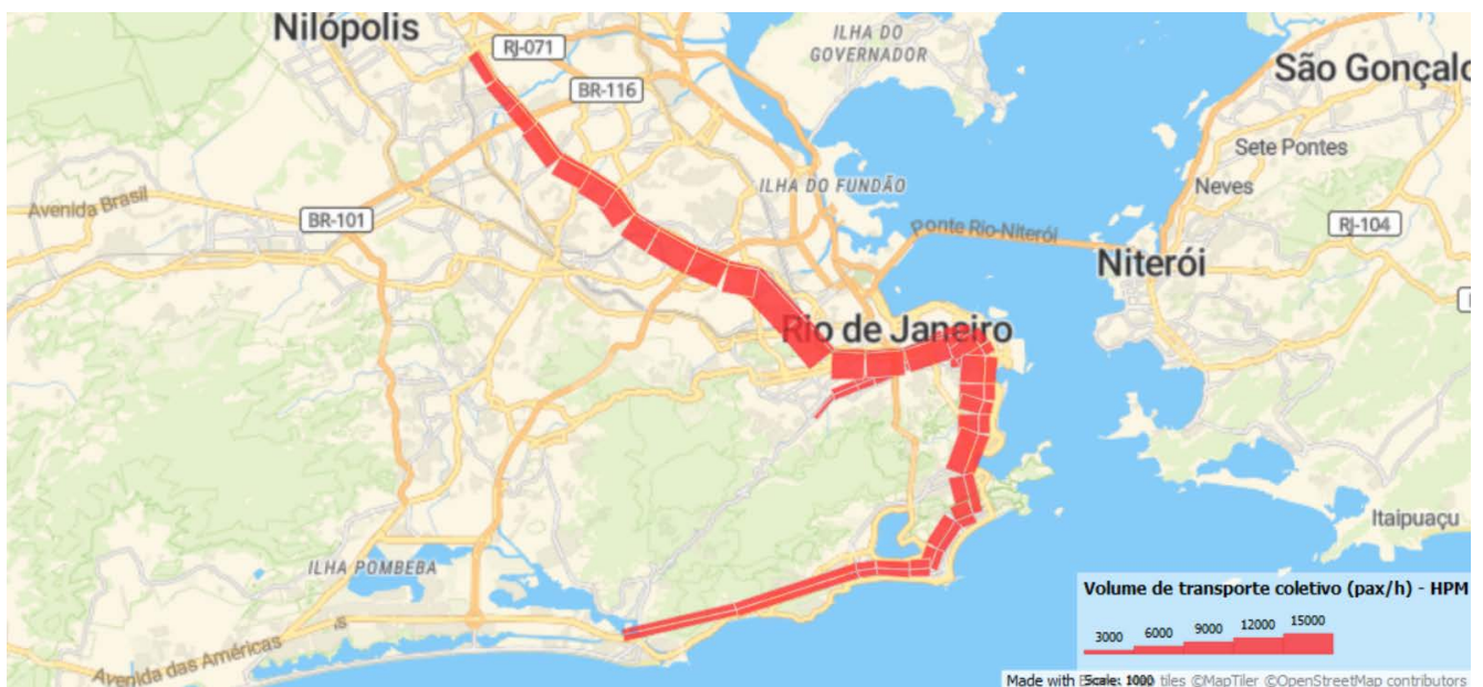
Figura 79: Carregamento do Metrô na HPM
