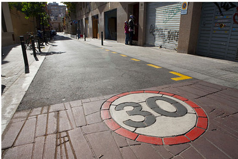
Figura 228: Demonstração de Sinalização, Rua e Calçadas Diferenciadas em Zona 30
