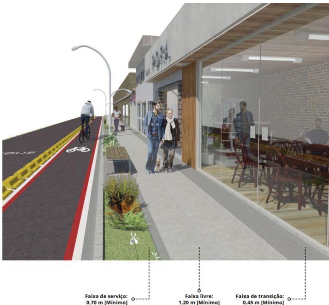
Figura 187: Recomendações de dimensionamento da largura das calçadas
