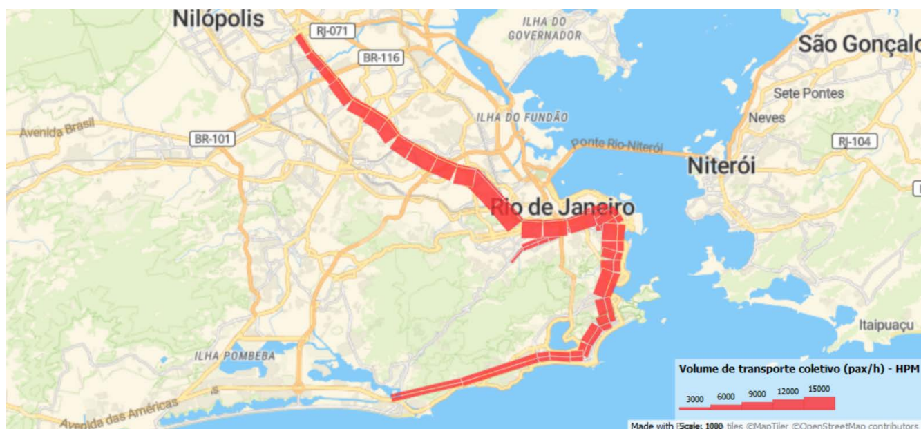
Figura 75: Carregamento do Metrô na HPM
