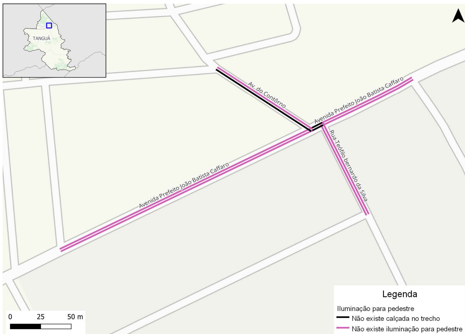
Figura 271: Iluminação para pedestre nas calçadas da rede inventariada de Tanguá
