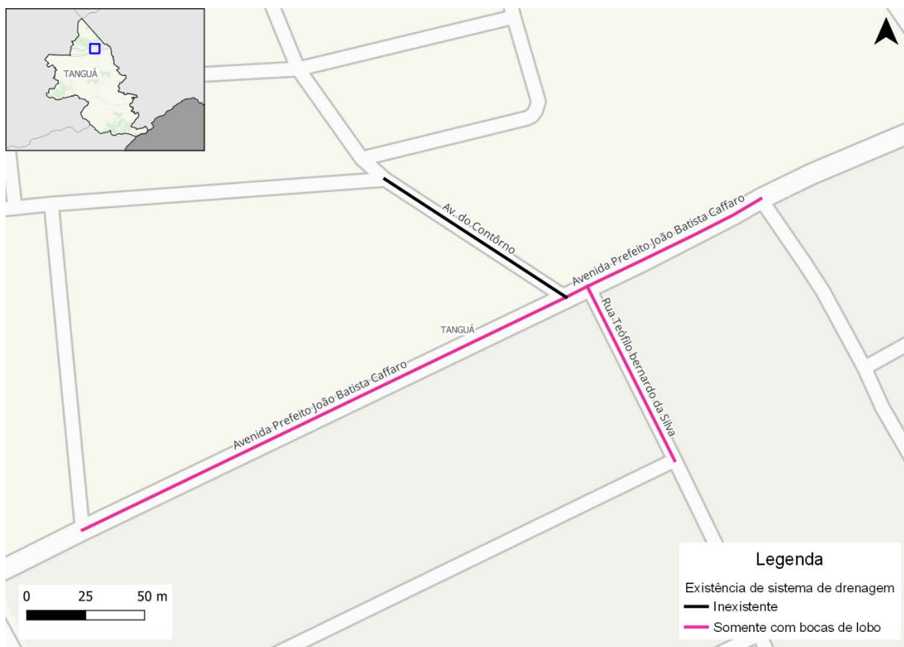
Figura 115: Sistema de drenagem na região central de Tanguá
