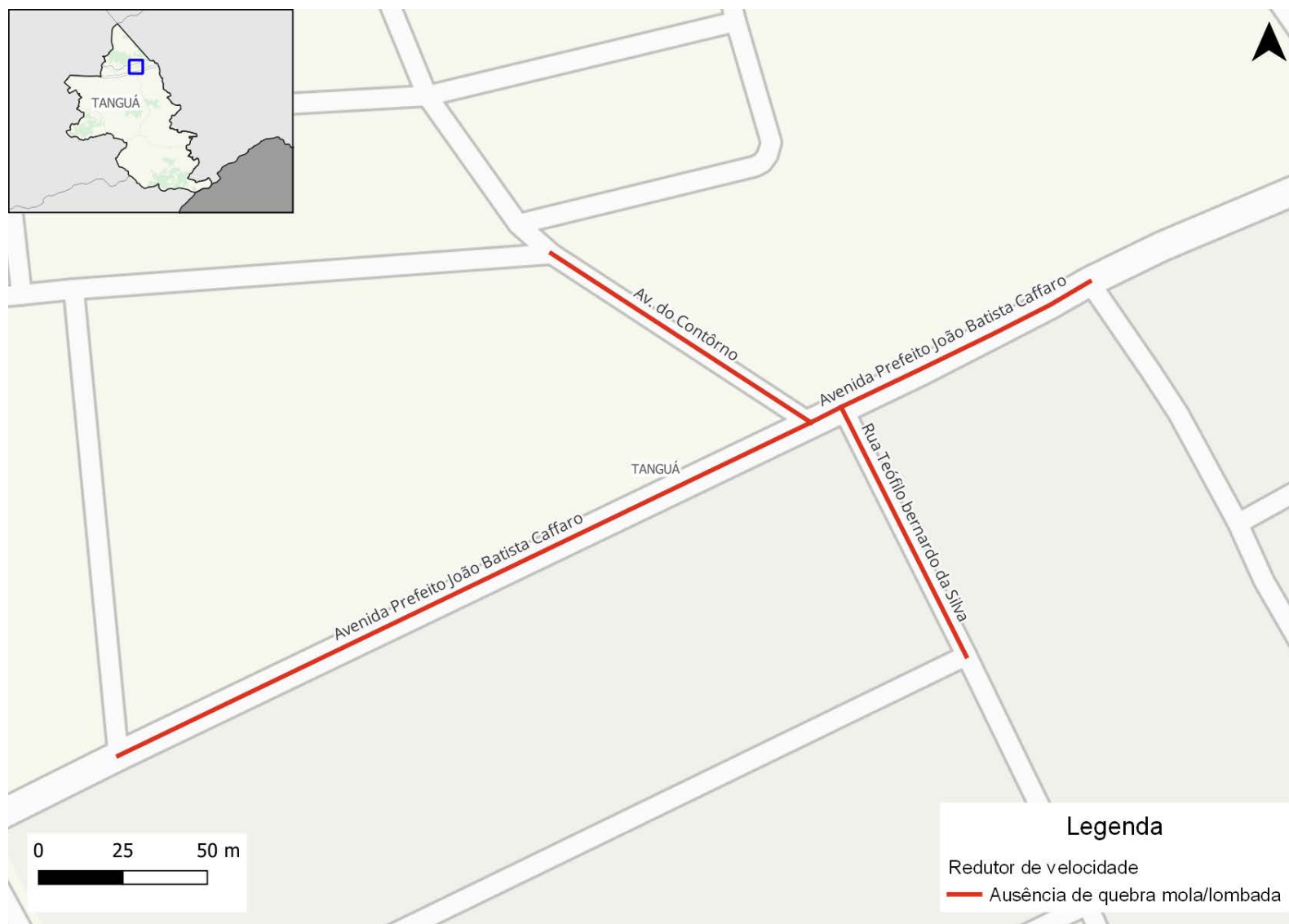
Figura 250: Elementos de redução de velocidade na rede inventariada de Tanguá
