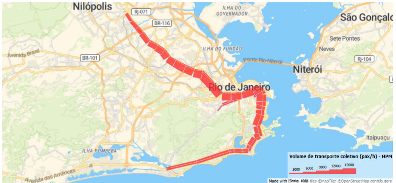
Figura 84: Carregamento do Metrô na HPM
