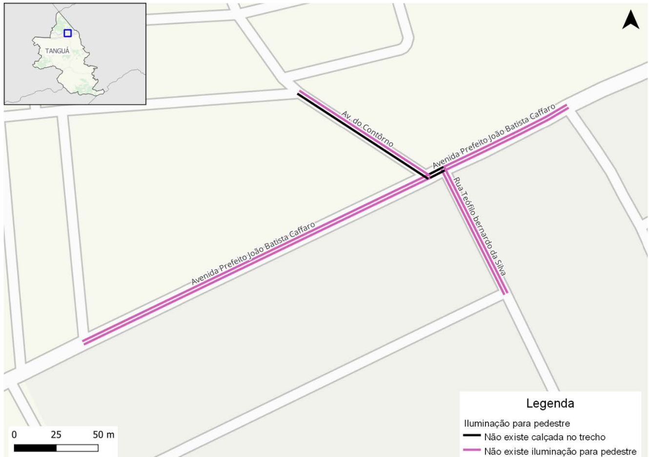
Figura 140: Iluminação para pedestre na área central de Tanguá
