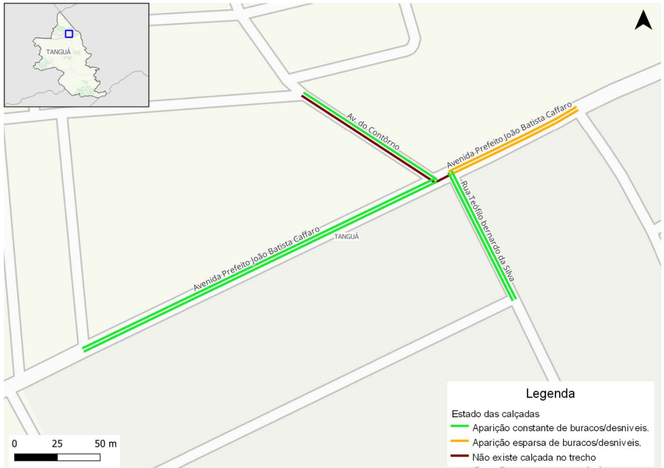
Figura 142: Estado das calçadas na área central de Tanguá
