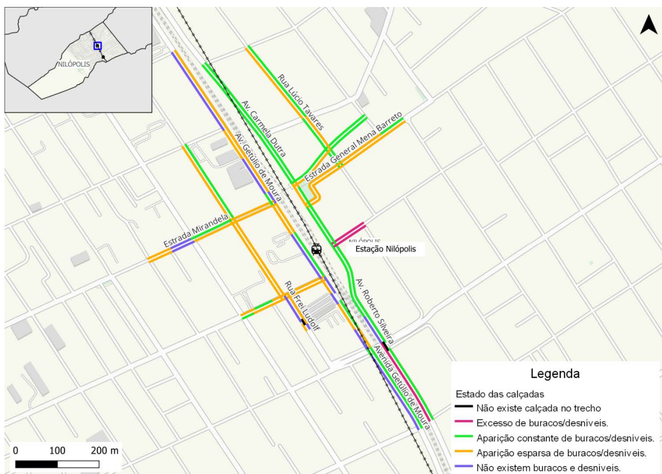
Figura 136: Estado das calçadas no entorno da estação de trem Nilópolis e Rodoviária
