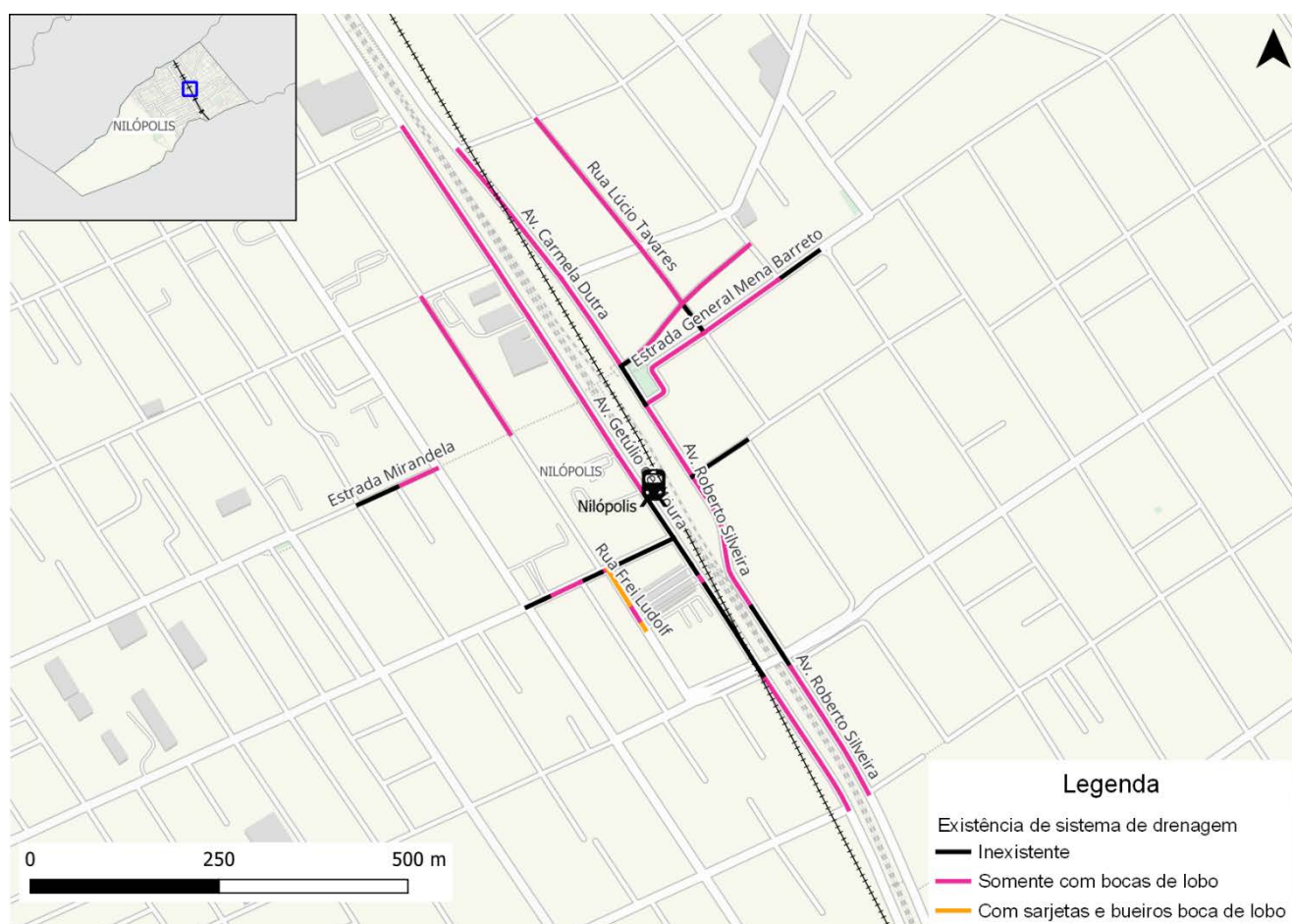
Figura 117: Sistema de drenagem no entorno da estação de trem Nilópolis e Rodoviária
