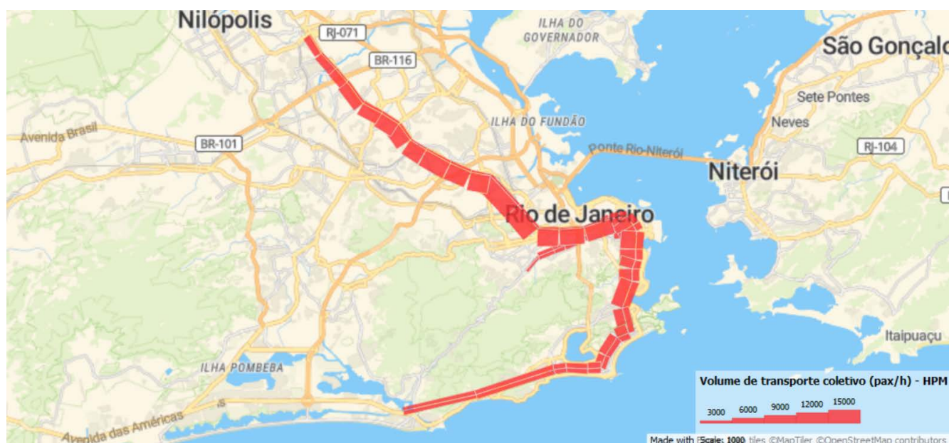
Figura 82: Carregamento do Metrô na HPM
