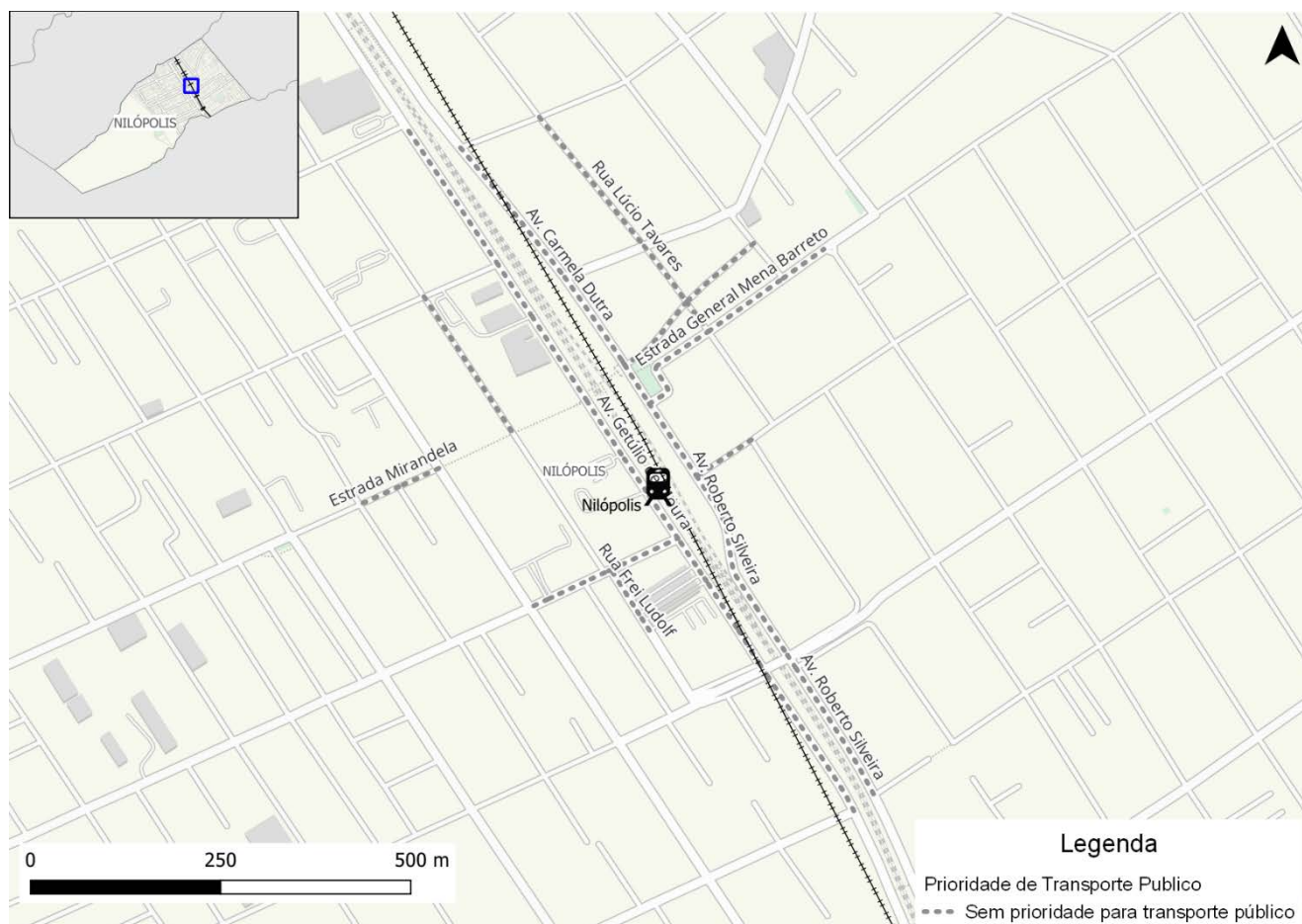
Figura 125: Ausência de prioridade física para transporte público coletivo no entorno da estação de trem Nilópolis e Rodoviária
