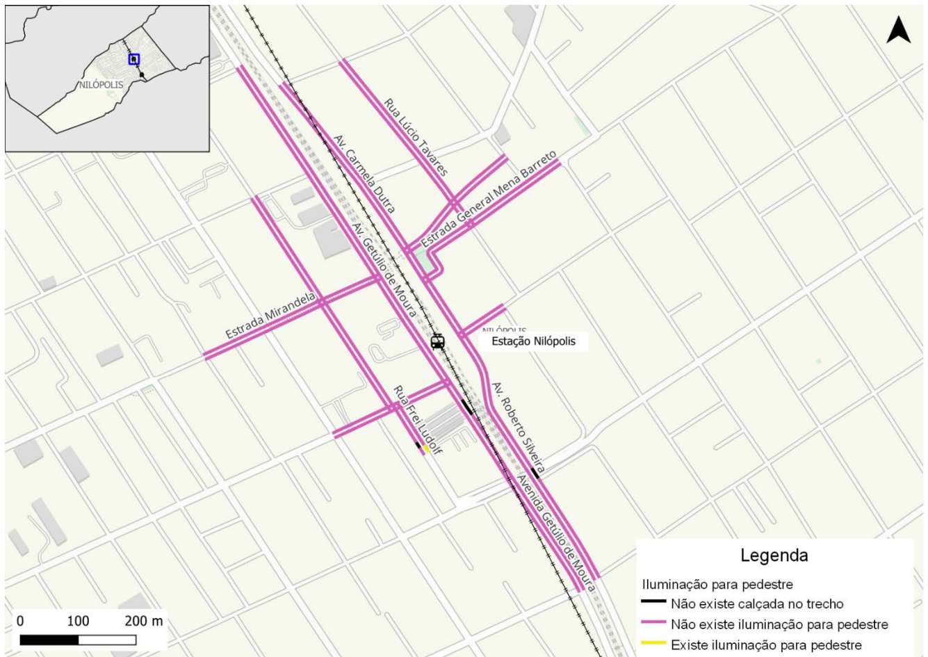
Figura 138: Iluminação para pedestre no entorno da estação de trem Nilópolis e Rodoviária
