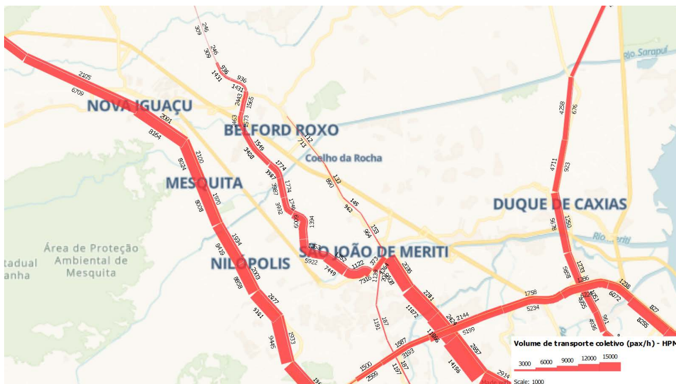
Figura 102: Carregamento VLT Pavuna, no horizonte 2034
