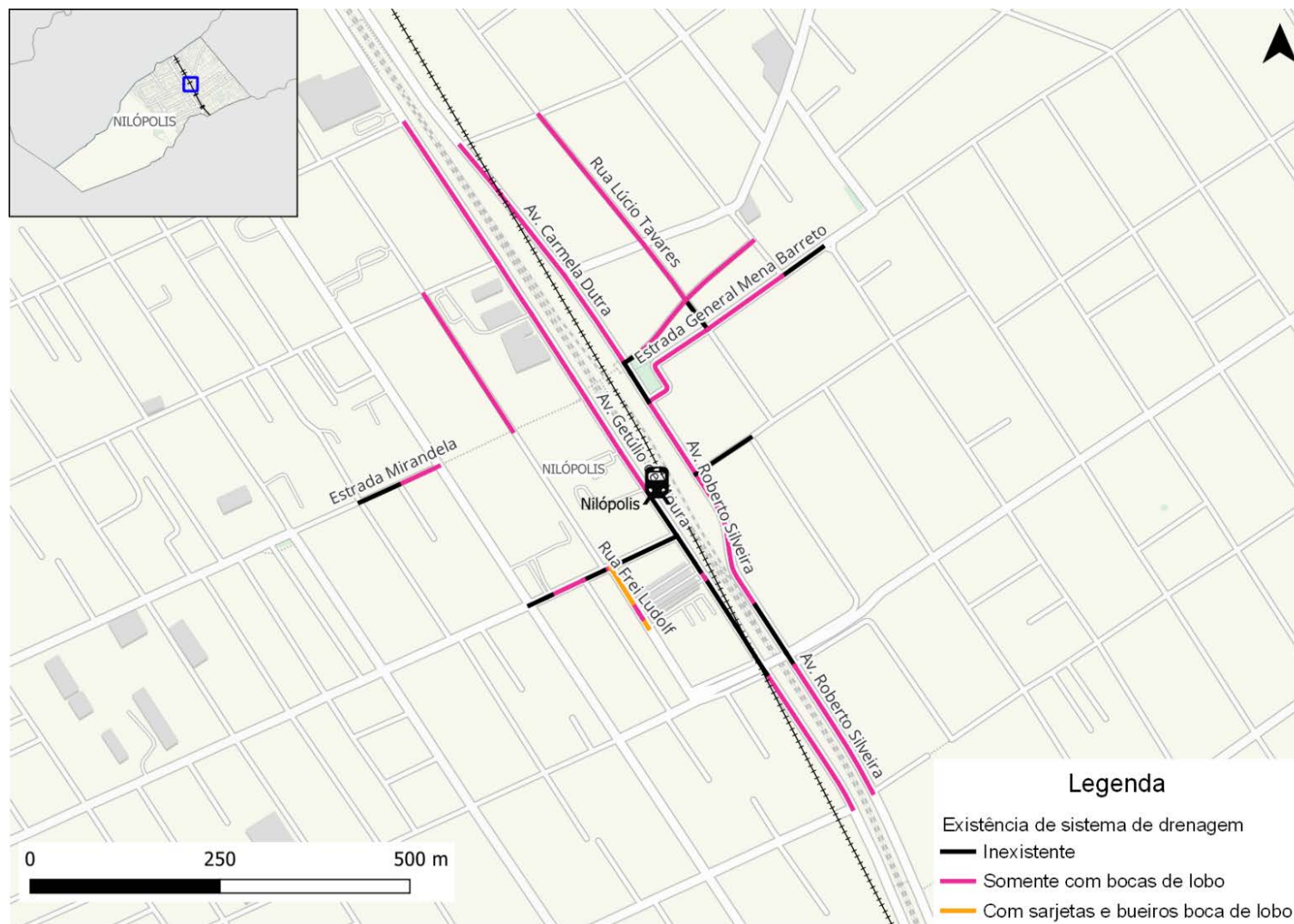
Figura 233: Equipamentos de drenagem na rede inventariada de Nilópolis
