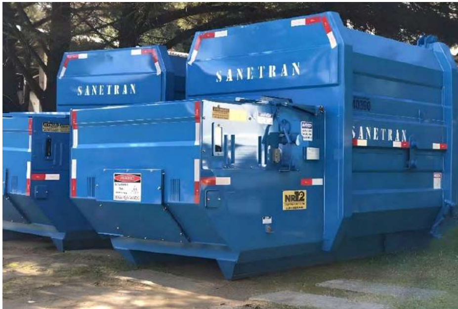
Figura 16: Compactadores Estacionários (Compactainer)
