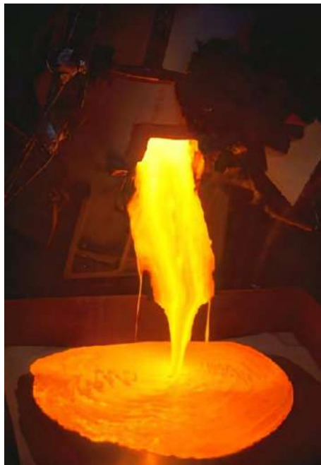
Figura 36: RSU Fundido em Reator com Tocha de Plasma
