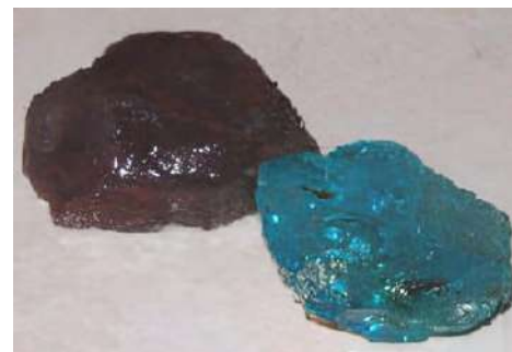
Figura 37: Mineral Vítreo – Fundo do Reator com Tocha de Plasma
