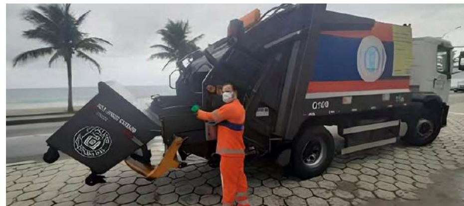
Figura 23: Caminhão Compactador com Lifter
