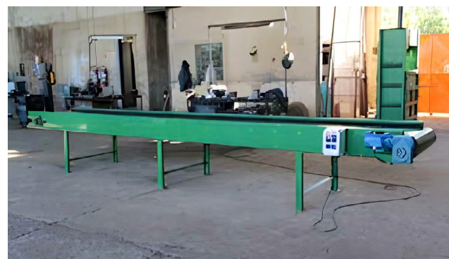
Figura 15: Esteira de catação
