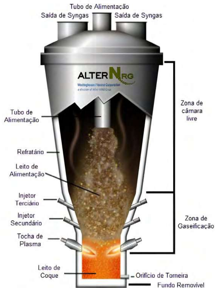
Figura 63: Reator do Processo de Tratamento de RSU por Tocha de Plasma
