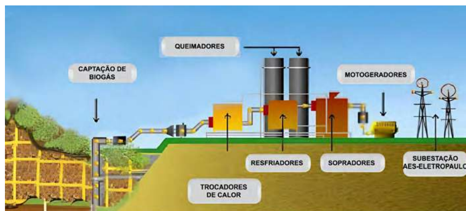
Figura 61: Fluxograma de Geração de Energia em Aterro Sanitário
