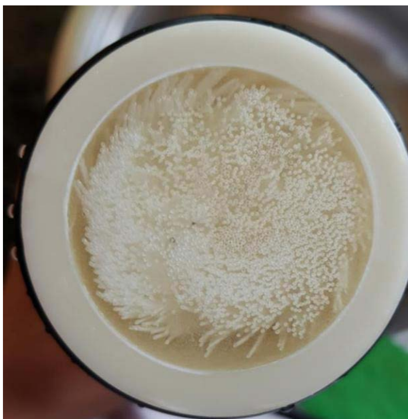
Figura 04: Vista Interna da Membrana (Autor)
