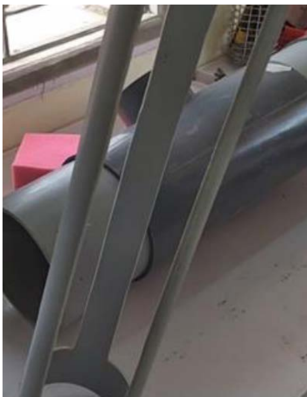
Figura 02: Filtro em tubo de PVC diâmetro 100 mm, envolto em tela com abertura de 1 mm
