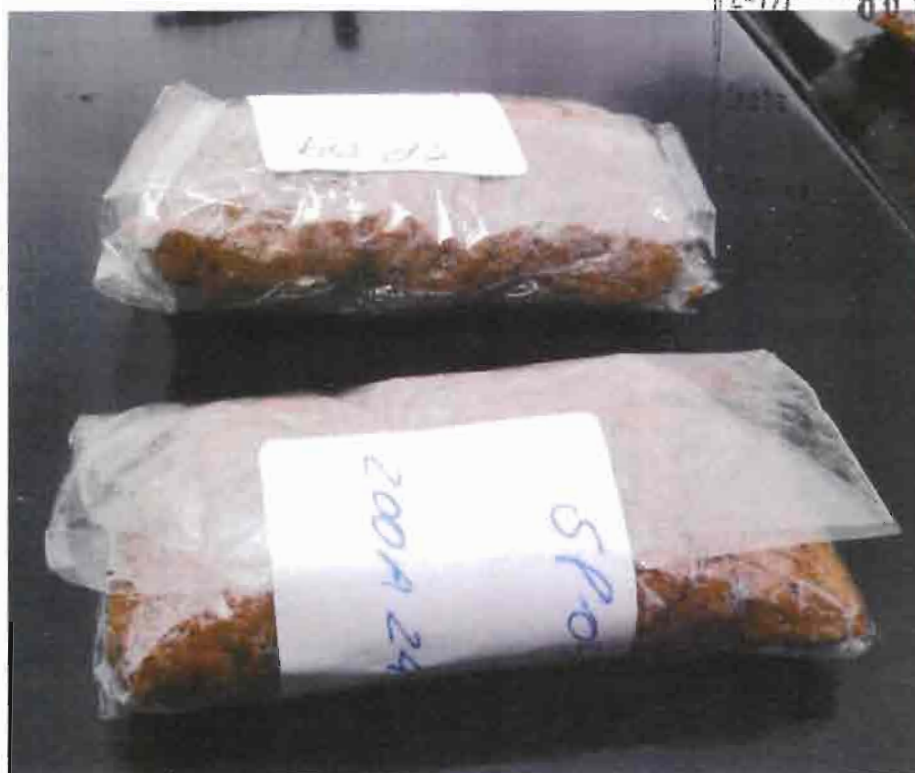
Figura 3. Detalhe da amostra da camada superficial de solo, com valores baixos de SPT.
