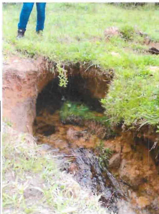
Figura 4: Detalhe do solo residual, com mica, com valores mais altos de SPT, mas, devido à sua textura arenosa, susceptível à erosão.
