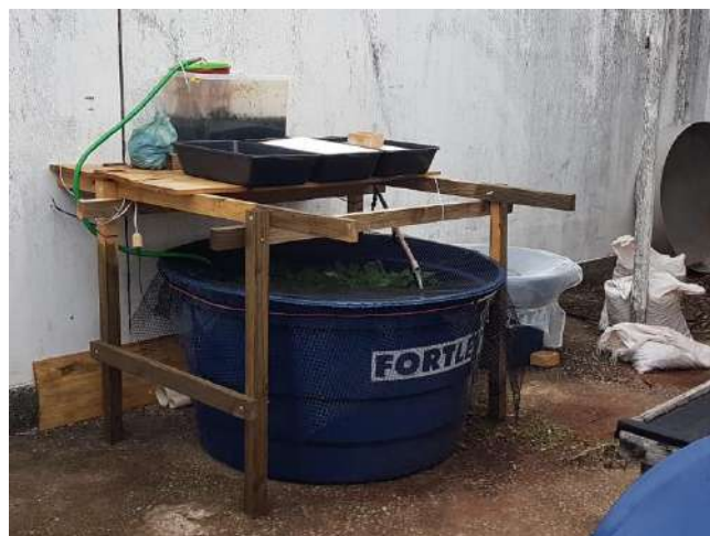
Figura 21. Foto da unidade experimental no modelo de aquaponia ainda em processo de construção.
