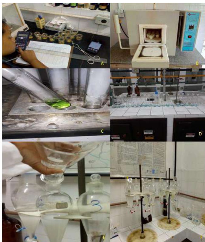
Figura 2: A. Cálculo de matéria seca de peixe Folha de Mangue ( Chloroscombrus chrysurus ) e Tira Vira ( Synodus intermedius ) através de método analítico com secagem em estufa realizado no Laboratório da Unidade de Tecnologia de Pescado – EEAAPM - Guaratiba. B. Matéria mineral obtida através de incineração em forno Mufla realizada no Laboratório da Unidade de Tecnologia de Pescado – EEAAPM - Guaratiba. D. Digestão de proteína e extração de nitrogênio das amostras de peixe Folha de Mangue e Tira Vira realizado no laboratório de química da Universidade Federal Rural do Rio de Janeiro e posterior destilação e titulação para cálculo de proteína bruta pelo método de Kjeldahl realizado no Laboratório da Unidade de Tecnologia de Pescado – EEAAPM - Guaratiba. . E e F. Extração de lipídeo bruto das amostras de peixe Folha de Mangue e Tira Vira pelo método de Folch realizado no Laboratório da Unidade de Tecnologia de Pescado – EEAAPM - Guaratiba.
