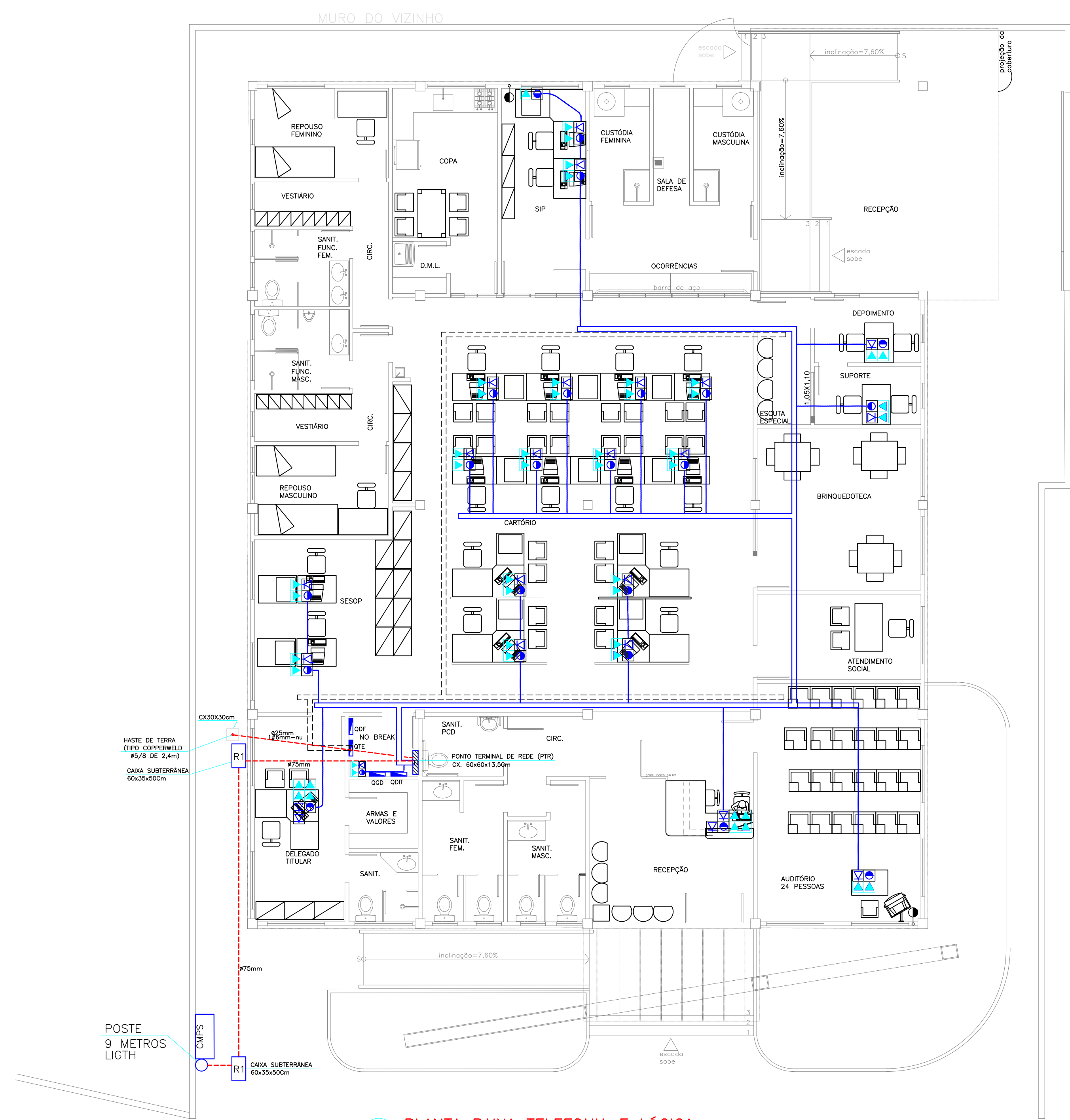
1 PLANTA BAIXA TELEFONIA E LÓGICA ESCALA 1:75
