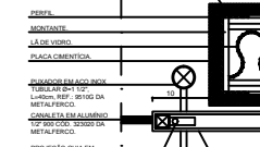
35 DET. 3 PORTA DE CORRER - CORTE ESC. 1:5
