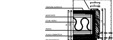
33 DET. 1 BATENTE TIPO - PINTURA / PINTURA ESC. 1:5
