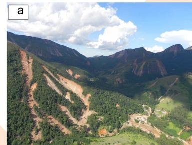
Figura 7a - Foto aérea dos deslizamentos dos taludes laterais.
