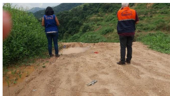
Figuras 4 e 5: Fotos retiradas do Laudo Técnico Emergencial de 2018, com vista do topo da cicatriz e feições indicativas de instabilidade.
