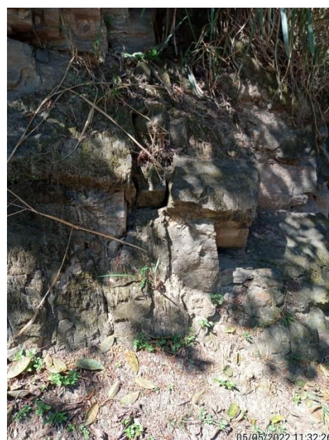
Figuras 4 e 5 – Fraturas subverticais interceptando a foliação. Destaca-se a individualização dos blocos que podem sofrer processo de queda na via.
