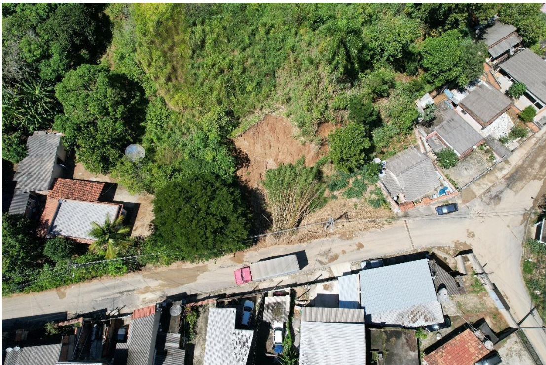
Figura 2: Imagem da cicatriz de deslizamento que mobilizou um bambuzal em direção a via, descrito em b).
