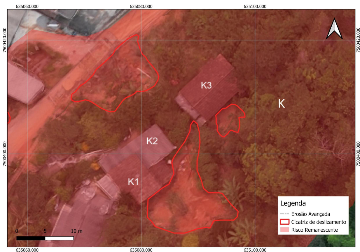
Figura 06: Mapa de Risco Remanescente da vistoria na Rua das Acácias, próximo ao nº 223 (no mapa, nº de edificação utilizada como referência do trecho).
