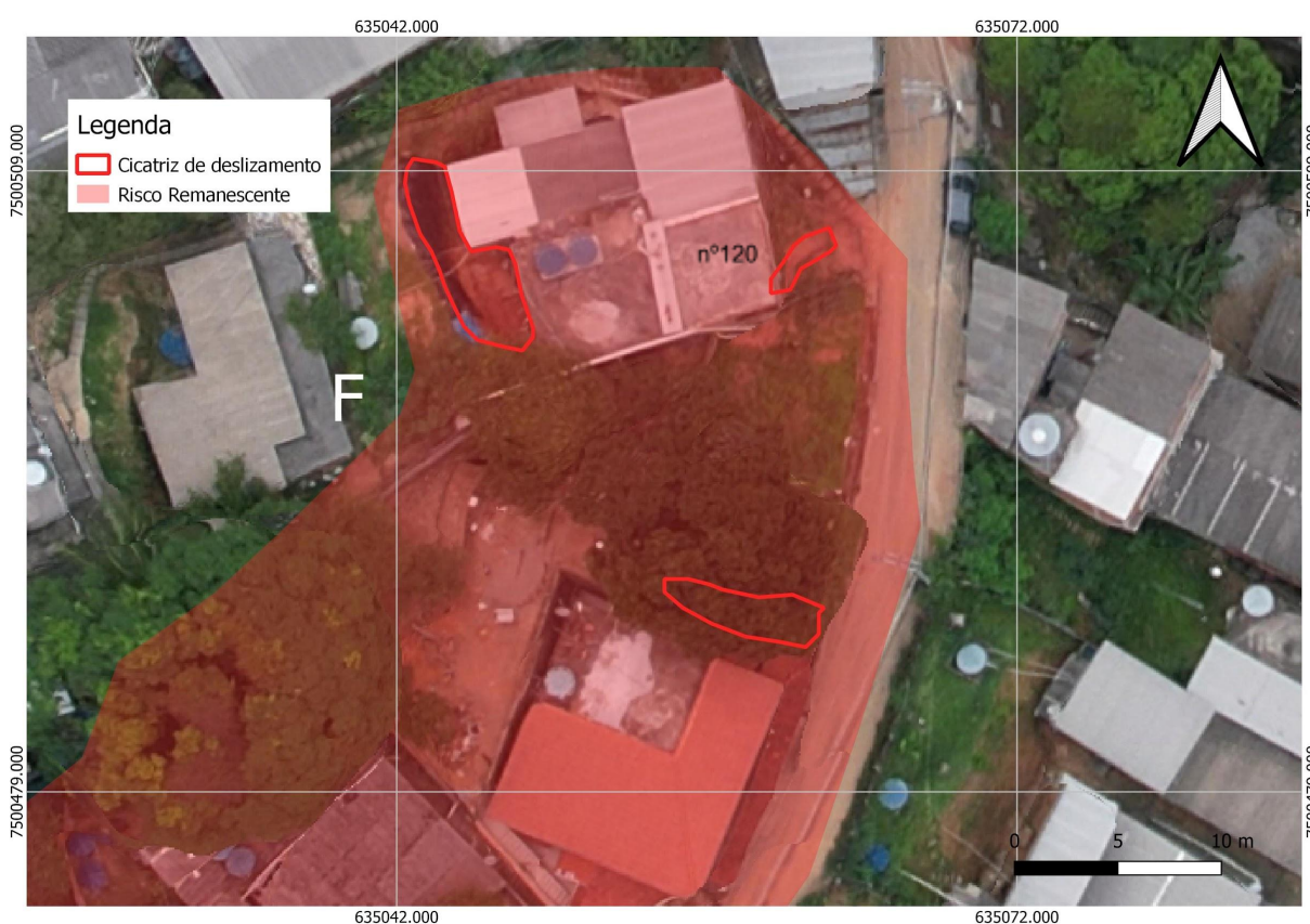
Figura 05: Mapa de Risco Remanescente da vistoria na Rua das Hortências, nº 120 (no mapa, nº de edificação utilizada como referência do trecho).
