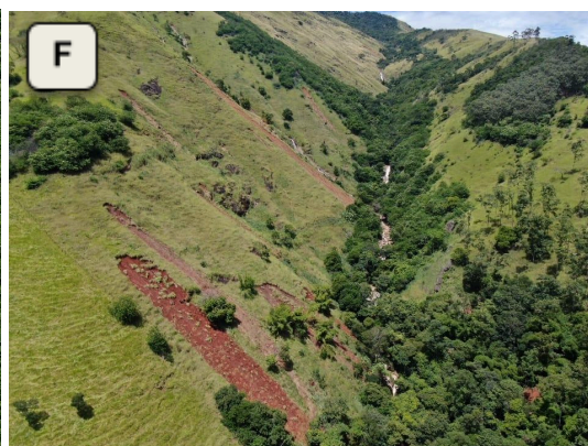
Figuras E e F: Deslizamentos planares rasos que tiveram seus fluxos de corrida encaixados na drenagem, colaborando para a geração de uma enxurrada.
