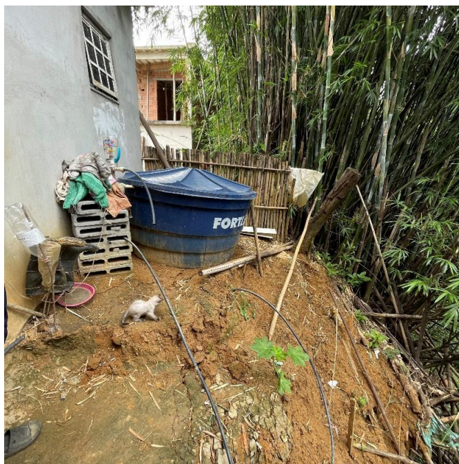
Figura 7: Presença de caixa d'água a uma distância nula da cicatriz de deslizamento
