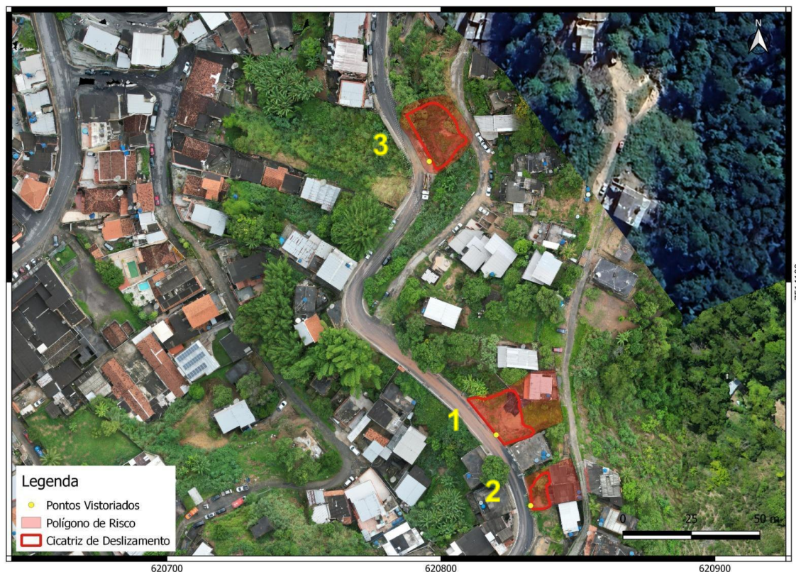
Figura 7: Delimitação de Risco Remanescente para as cicatrizes de deslizamento 1 e 2 na Rua Humberto Ferraz e para a cicatriz 3 na Rua Expedicionário Jalber Coelho da Silva - Morro do Gama.
