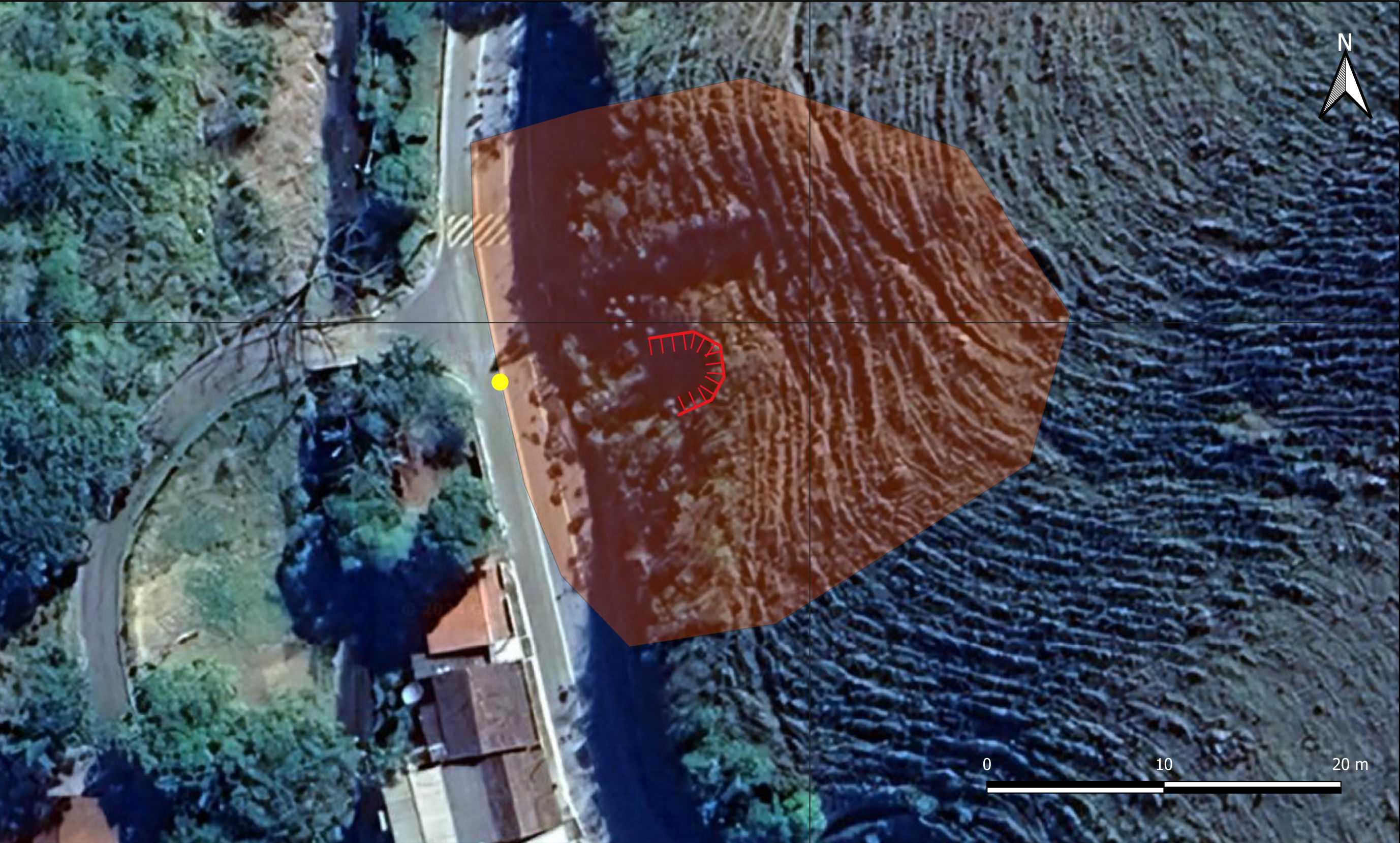
Material da encosta proveniente do deslizamento pretérito que avançou até a lateral da via, obstruindo parcialmente a canaleta, porém não atingiu a via ou casas. Observar que a vegetação já está recomposta, mostrando que se trata de um movimento antigo.
