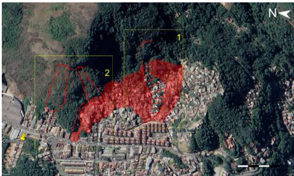
Figura 1. Delimitação do risco remanescente nas áreas 1 e 2 do Morro da Oficina. A área hachurada equivale à área atingida pelo movimento de massa.
