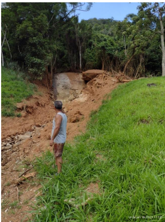
Figuras 3 e 4: Vista do trecho escorregado, com o bloco individualizado; Detalhe da laje de rocha exposta e do matacão deslocado.
