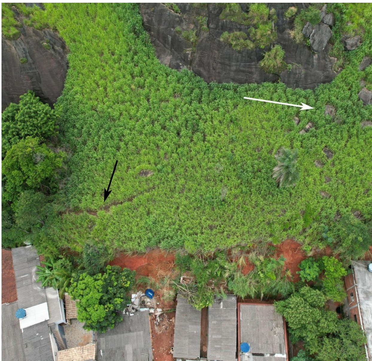
Figura 2: Identificação da trinca de tração (seta preta) e depósito de tálus (seta branca) na encosta pela imagem aérea.
