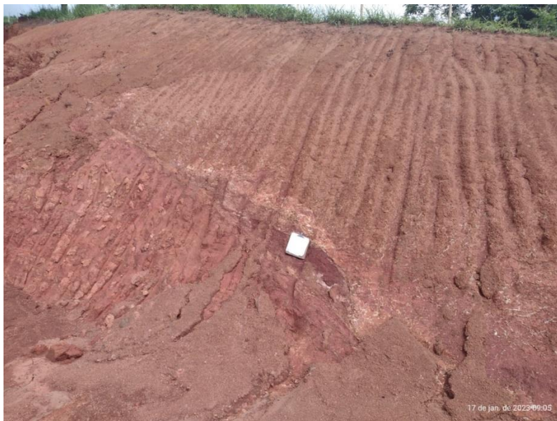
Figura 3: Talude lateral onde é possível identificar o solo residual jovem.
