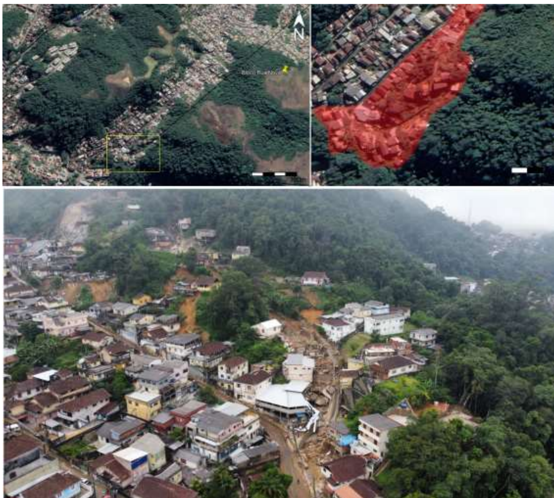
Figura 2. Imagem mostrando a localização da área de risco, delimitação da interdição e fotografia por drone mostrando as cicatrizes e casas afetadas (inferior).
