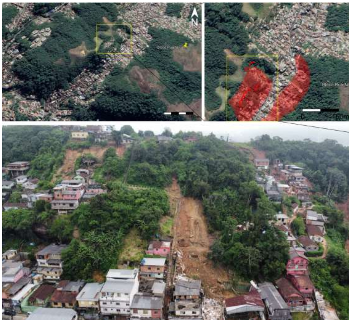
Figura 4. Imagem mostrando a localização da área de risco, delimitação da interdição e fotografia por drone mostrando as cicatrizes e casas afetadas (inferior).
