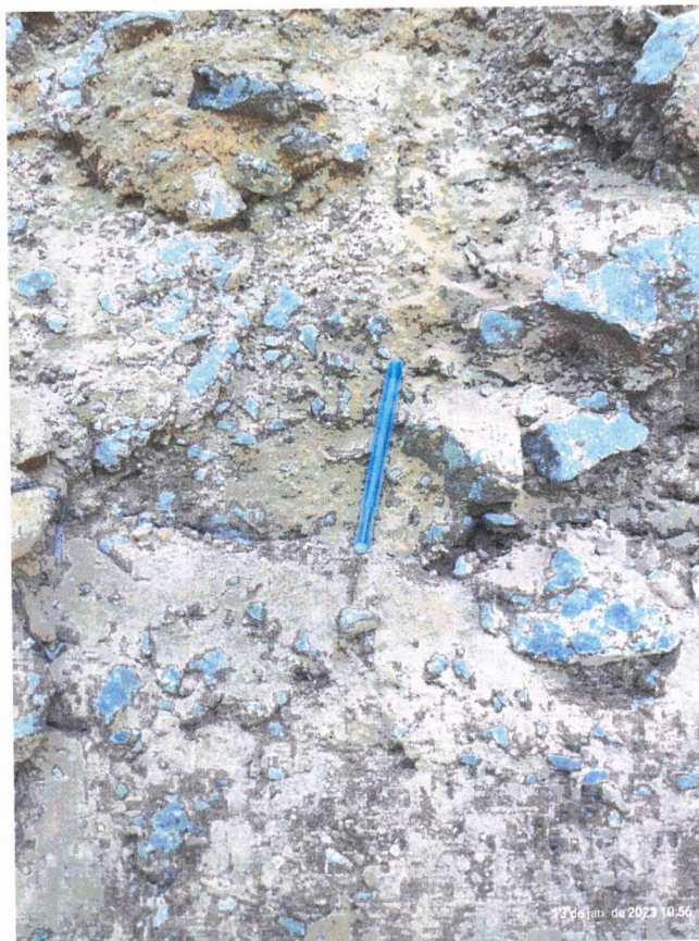
Foto 5- Perfil intemperizado, tendo na base fragmento da rocha básica e no topo inpermeização do gnaiss migmatítico.
