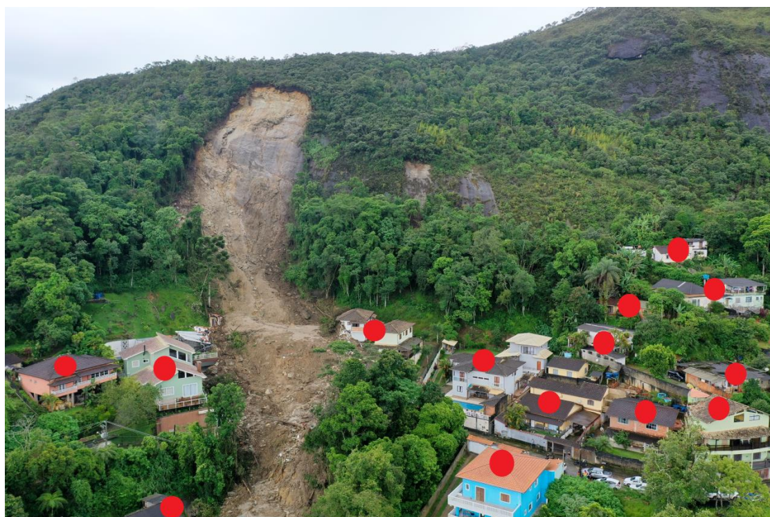
Figura 1. Identificação das quatorze residências interditadas no entorno do movimento gravitacional de massa.
