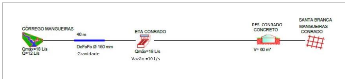
Figura 12: Diagrama unifilar do SAA de Conrado
