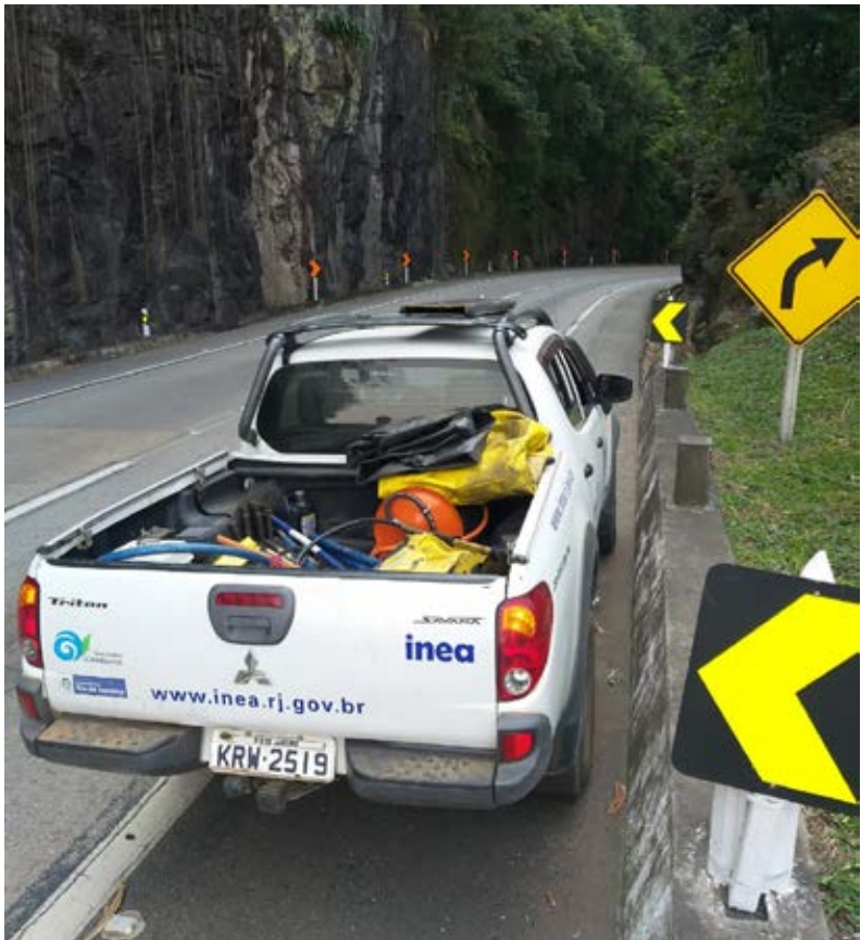
Figura 56 - Veículo com equipamentos de prevenção e combate
