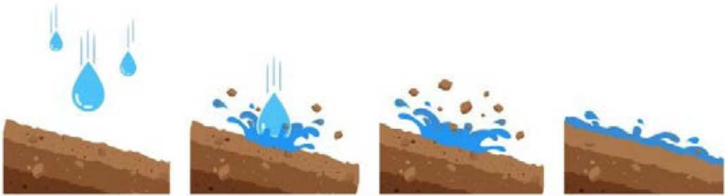
Figura 37 - Efeito splash provocando o início do processo erosivo
