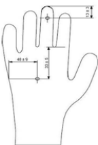
Figura A.2 - Pontos de medição para espessura da luva
