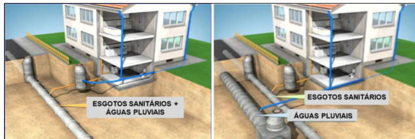
Figura 2: Sistemas de esgotamento sanitário do tipo unitário e separador absoluto
