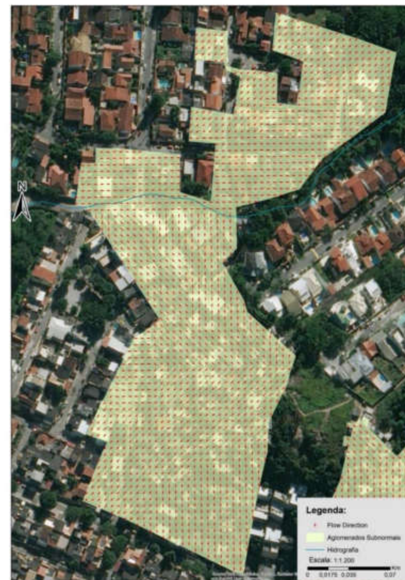
Figura 40: Definição das áreas de contribuição das microbacias de drenagem no limite de cada aglomerado subnormal com emprego de ferramenta FlowDirection-Arcgis
