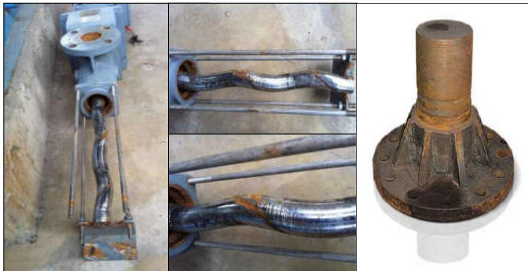
Figura 22: Efeitos de abrasão sobre peças de equipamentos de bombeamento
