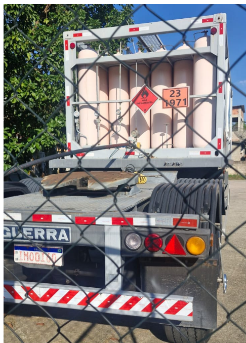
Foto 6: Carreta de transporte de GNC.
