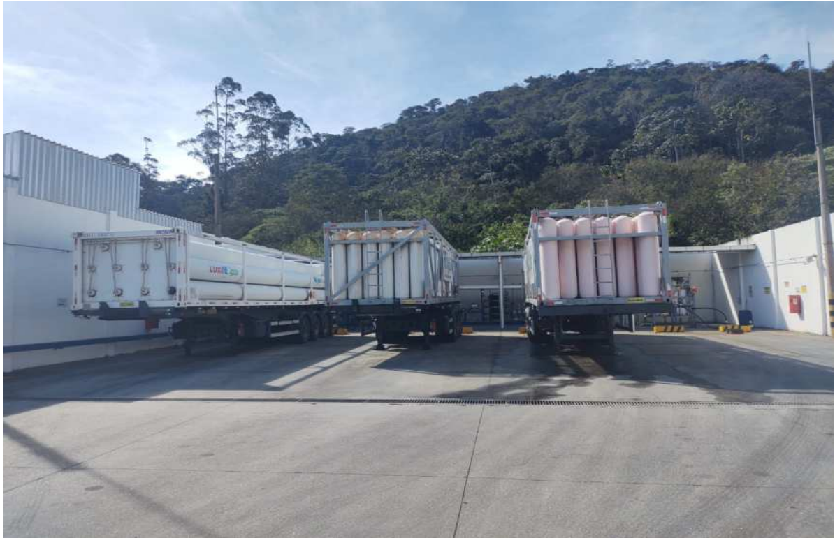
Foto 3: Carretas usadas no transporte de cilindros verticais de GNC, a uma pressão de 250 bar.
