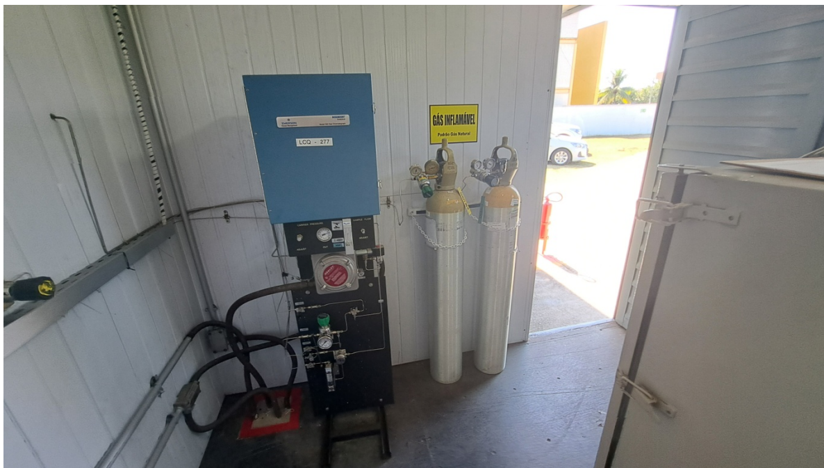
Foto 9: Cromatografia Gasosa e Cilindros com Mistura Padrão de GN
