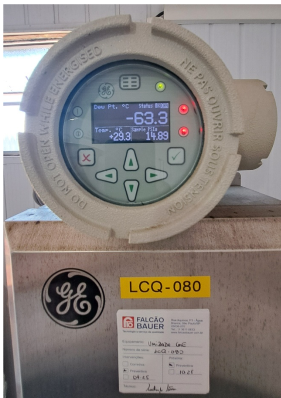
Foto 10: Medição de Temperatura e Ponto de Orvalho do GN
