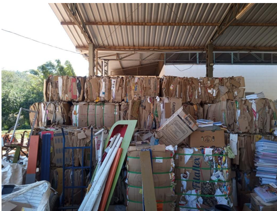
Figura 21: Unidade de triagem da coleta seletiva . Papelão separado e enfardado
