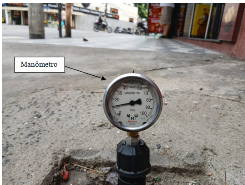
Foto 1 –Pressão manométrica de 12 MCA
