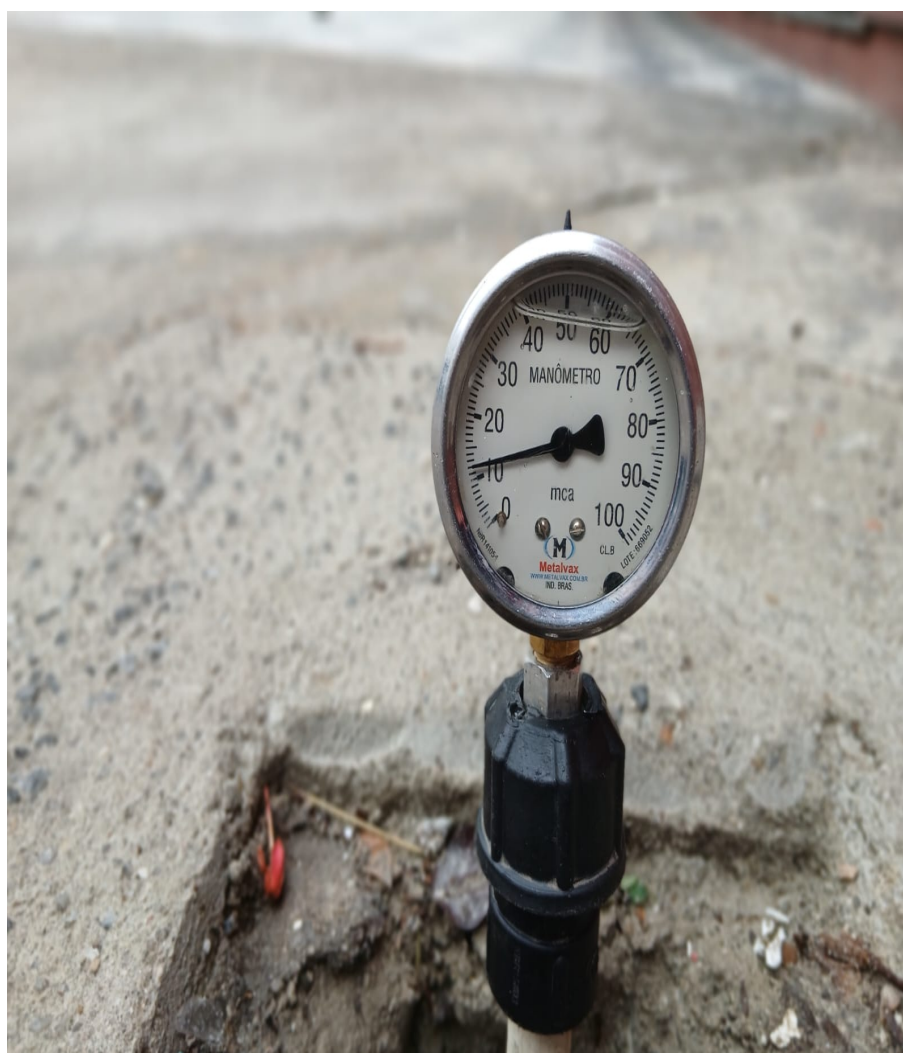
Foto 2 –Pressão manométrica de 12 MCA
